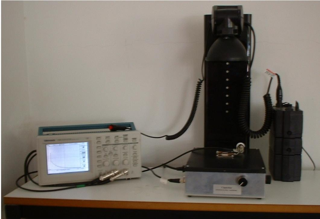
Figure 4.10 – Vue de l'appareil de photoconductivité Sinton WCT-100
