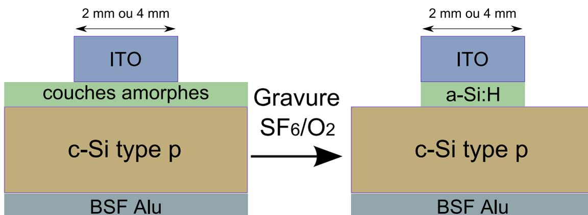
Figure 3.2 – Vue de côté des cellules avant et après gravure
