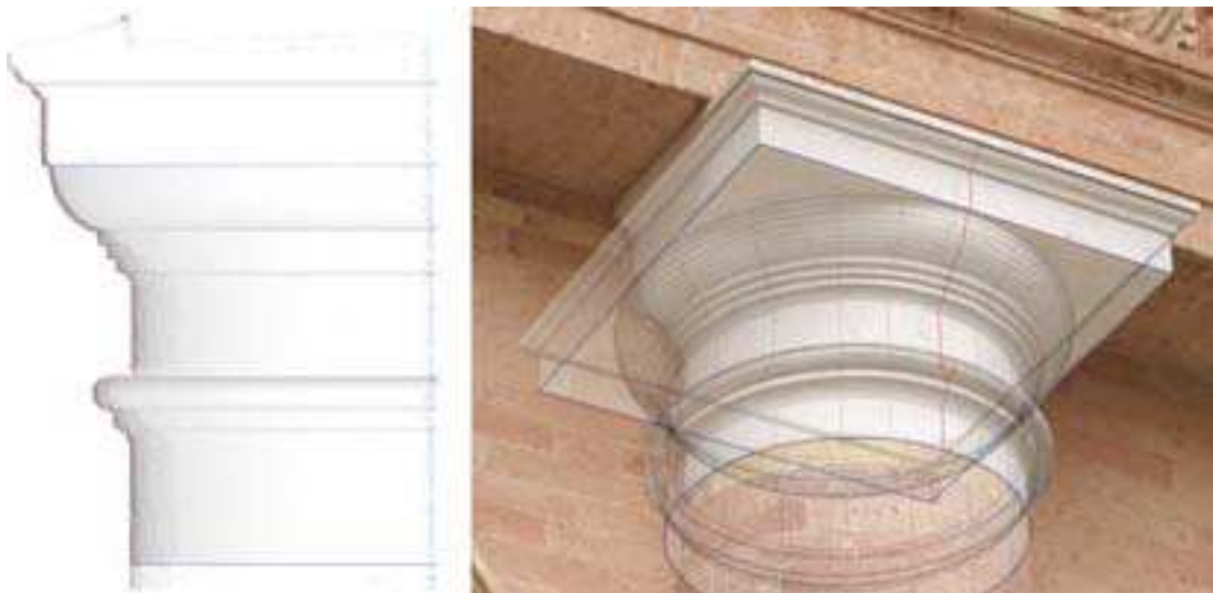
Figure 56. La primitive instanciée sur le nuage de points. À gauche, une vue sur le profil vertical. À droite, une vue sur une photographie orientée sur le nuage de points.
