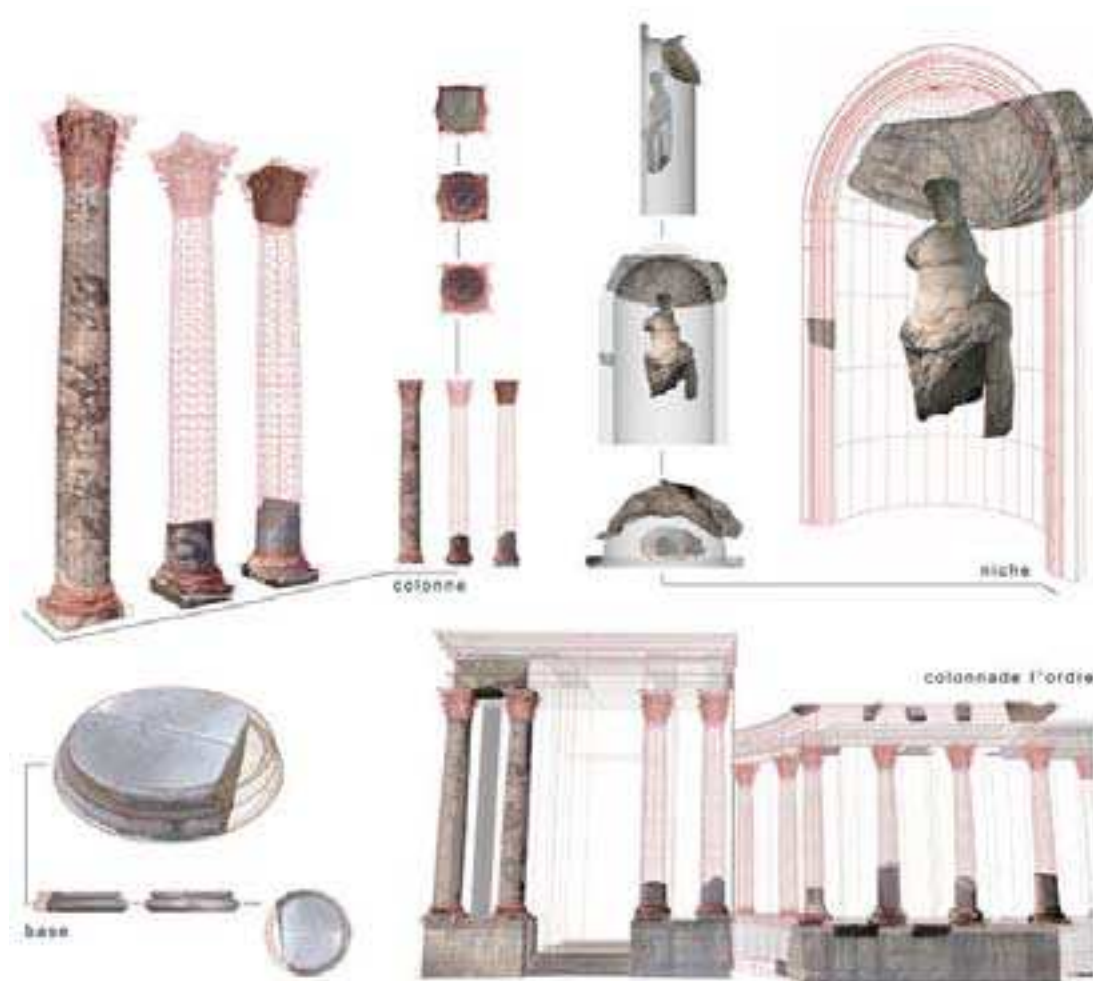
Figure 94. Des modèles théoriques (en filaire) instanciées sur la morphologie relevée des vestiges du théâtre romain d'Arles.
