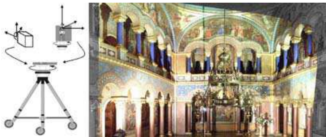
Figure 20. À gauche, le principe de l'acquisition des données par le capteur laser et la caméra HD. À droite, le hall du château Neuschwanstein : l'image de luminance du scanner est mélangée avec les valeurs RVB correspondantes acquises par la caméra. Dans [Abmayr et al.; 2004].
