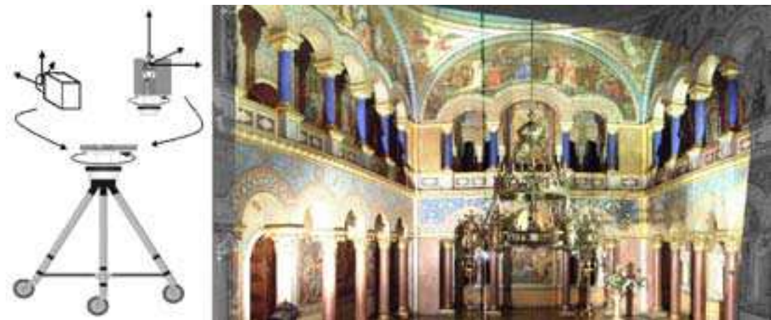
Figure 20. À gauche, le principe de l'acquisition des données par le capteur laser et la caméra HD. À droite, le hall du château Neuschwanstein : l'image de luminance du scanner est mélangée avec les valeurs RVB correspondantes acquises par la caméra. Dans [Abmayr et al.; 2004].
