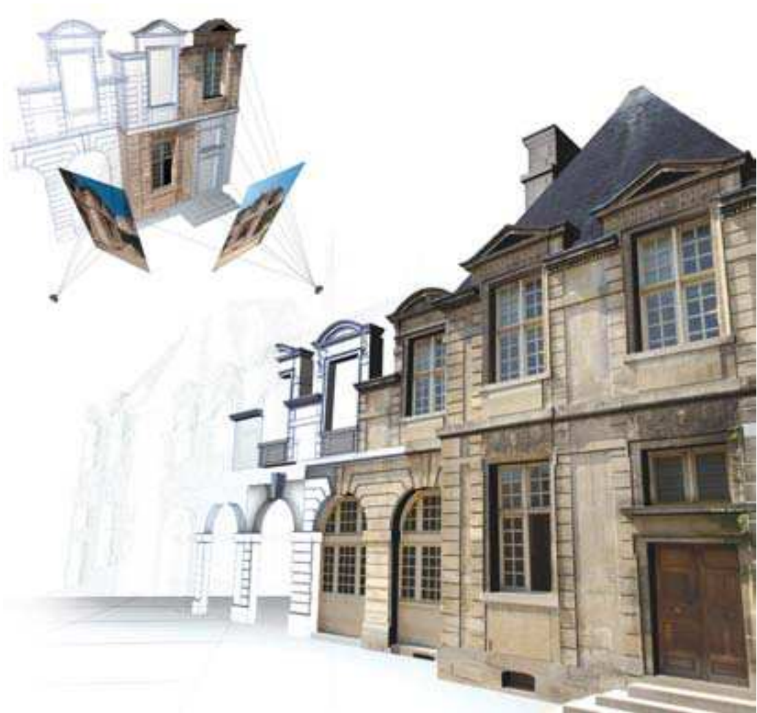
Figure 78. Extraction et plaquage des textures à partir de photographies orientées. Orangerie, Hôtel de Sully, Paris.
