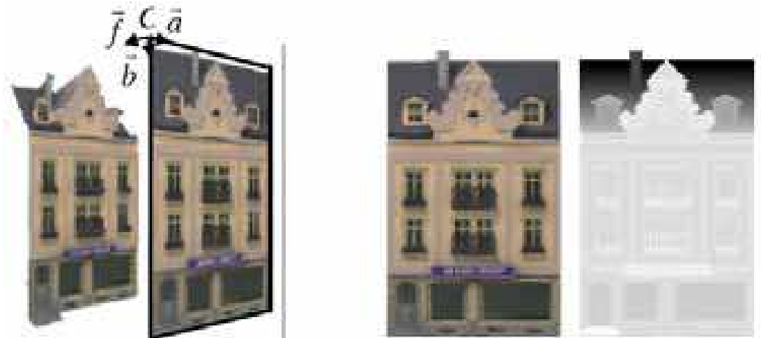
Figure 13. Le processus de construction d'une texture avec relief. À gauche : la surface correspondante est projetée de façon orthogonale dans un plan de référence et la profondeur est mesurée comme la distance par pixel du plan au point échantillonné. À droite : les composantes couleur et profondeur correspondantes de la texture relief résultante. Dans [Oliveira et al., 2000].
