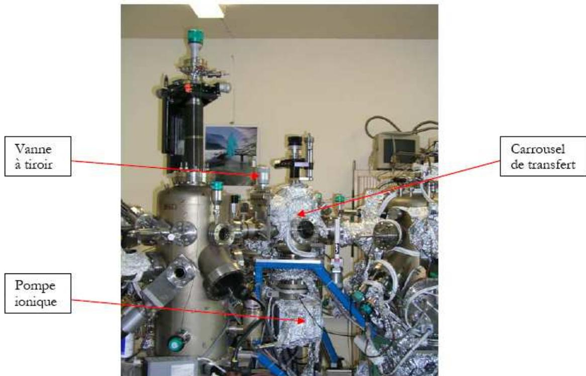
Figure 30 : Photographie de la partie introduction, stockage et transfert de la manip. XPS
