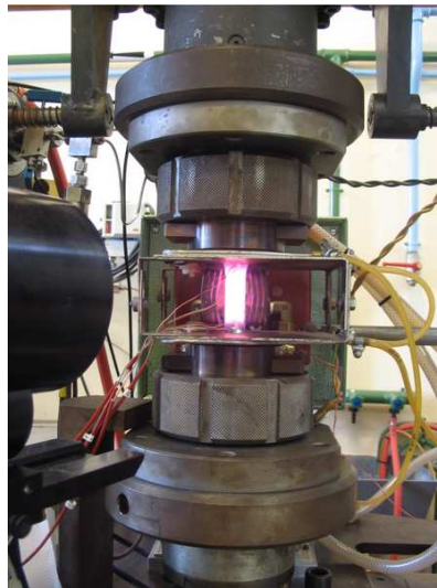
FIG. 3.19 – Dispositif de chauffage où l'on peut voir les thermocouples, l'inducteur et la cage de Faraday
