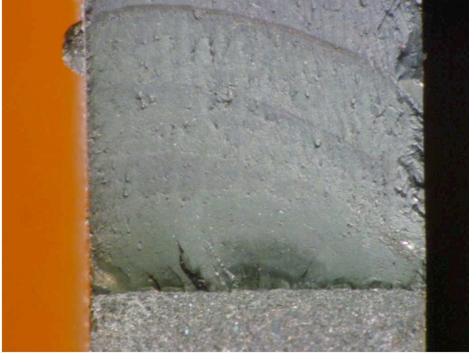
FIG. 6.36 – Front de propagation de la fissure pour une éprouvette trouée d'épaisseur 5 mm et de rayon de trou de 2 mm sollicitée en régime de fatigue (5 Hz) (observation de Wicker [161]).
