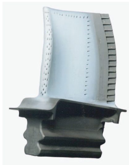
FIG. 1.2 – Aube de turbine haute pression du moteur M88.
