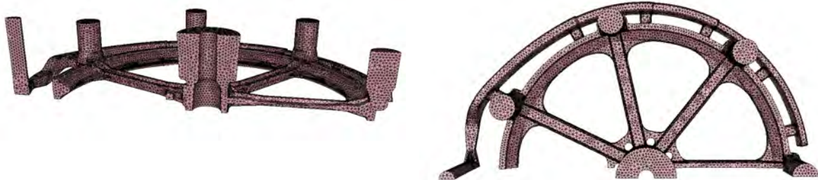
Figure 159 : maillage de la roue à sept branches
