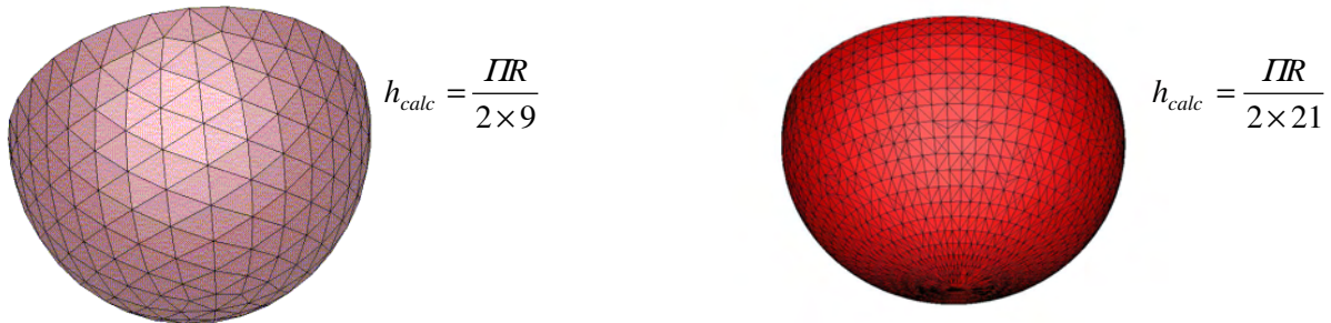
Figure 73 : maillage fin et grossier, et estimation du diamètre des éléments
