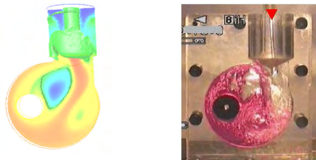
Figure 157 : Comparaison qualitative de l'écoulement dans la maquette [Abouchadi, 2002] avec la simulation REM3D® au temps t = 0,1[s] , avec P_{entrée} = 3000[Pa] , v_{fluide} = 0.001[m^2.s^{-1}] , v_{air} = 0,01[m^2.s^{-1}] , et \Delta t = 0.0001[s]
