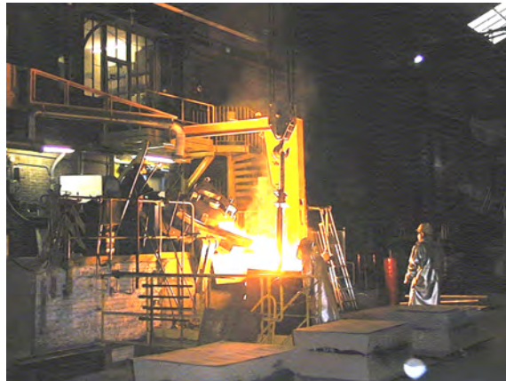
Figure 2 : coulée d'un lingot destiné à être forgé (Aubert et Duval)
