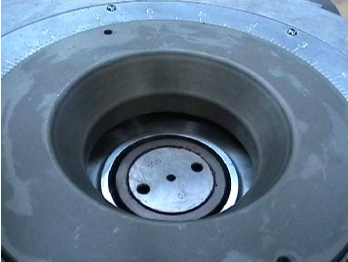
Anneau de refroidissement utilisé avec la filière de petite taille. Diamètre interne de l'anneau de refroidissement = 125 mm Profondeur = 40 mm
