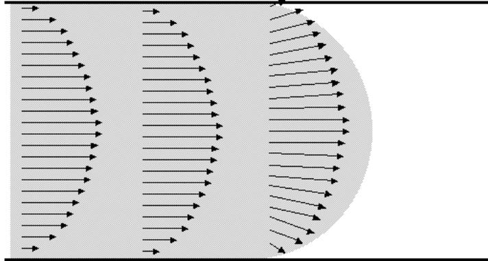
FIG. 1.3 – Représentation du champ de vitesse dans un écoulement de Poiseuille et dans le repère du laboratoire. Variation de l'orientation du champ de vitesse au front de matière.
