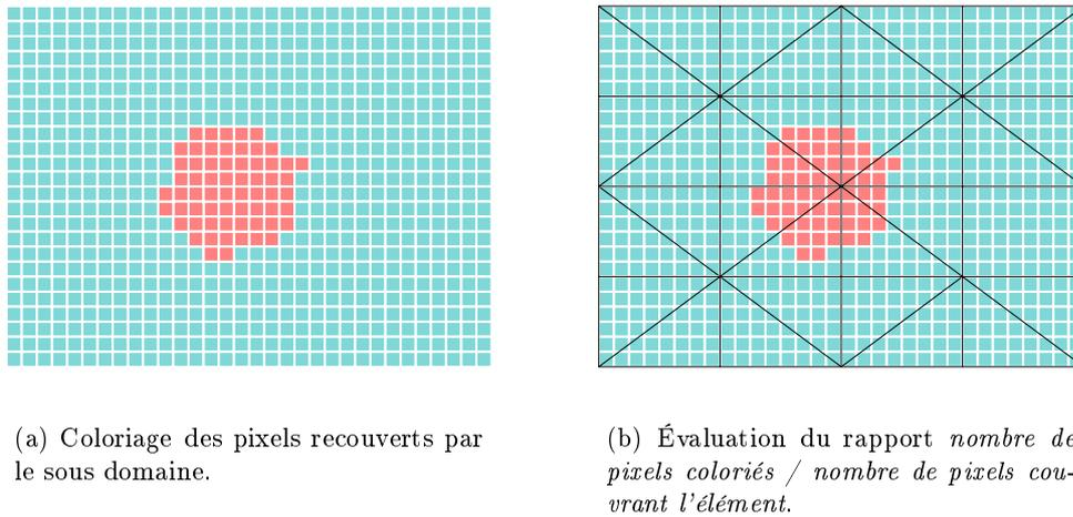
FIG. 3.17 – Initialisation de la fonction caractéristique relative au sous domaine rouge.
