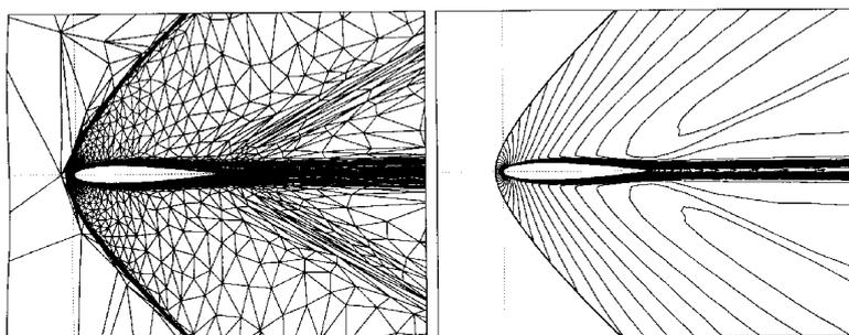
FIG. 2.1 – Exemple de calcul sur un champ anisotrope (tiré de [Castro diaz et al.95]).
