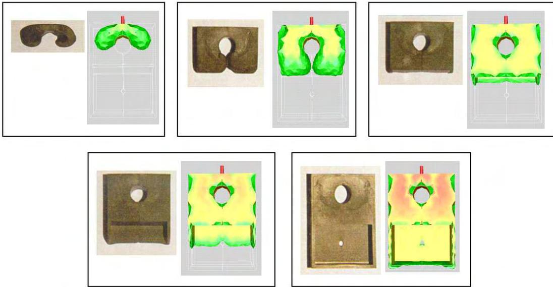
FIG. 4.5 – Comparaison calculs/essais.
