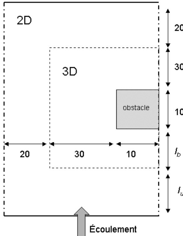
FIG. 1.6 – Géométrie de l'écoulement autour d'un obstacle.
