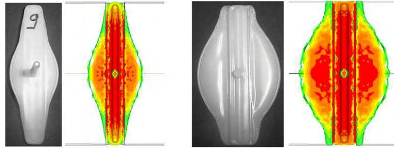
(a) Remplissage de la zone du distributeur. (b) Début du remplissage en nappe.
