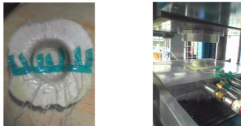
FIG. 3.13: Disposition des thermocouples sur le flan étudié.
