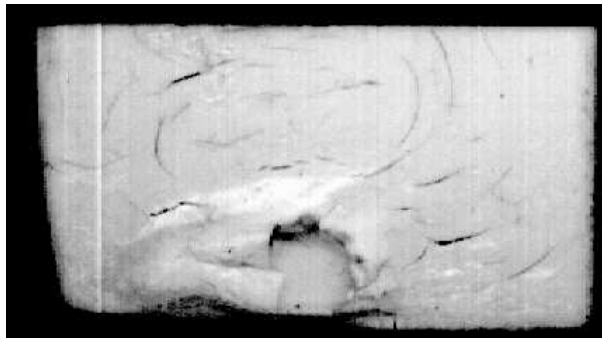
FIG. 3.37 – Formation de cloques à la surface de l'échantillon de polystyrène durant l'absorption de pentane. On peut également distinguer des déformations à la surface de l'échantillon.
