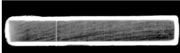
FIG. 4.2 – Localisation de l'absorption du pentane par l'échantillon de polystyrène dans la couche superficielle brillante. Les molécules de pentane n'ont pas eu le temps de diffuser au coeur de celui-ci (en gris foncé); la profondeur de pénétration est d'environ 1 \text{ mm} .
