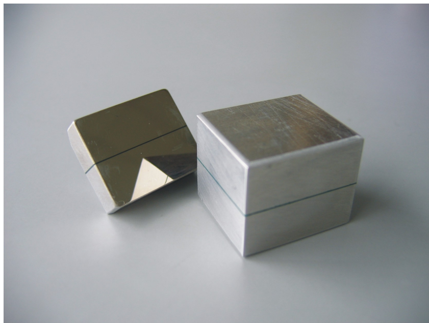
FIG. 4.11 – Préparation d'une éprouvette destinée à la microanalyse X : bloc initial et coupe poli miroir d'un joint de 300 \mu\text{m} d'épaisseur.
