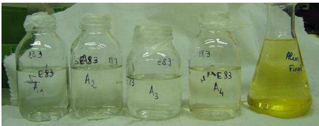
Figure IV-19 : Aspect du rétentat-entrée lors de l'augmentation du FRV avec le condensat industriel à pH naturel
