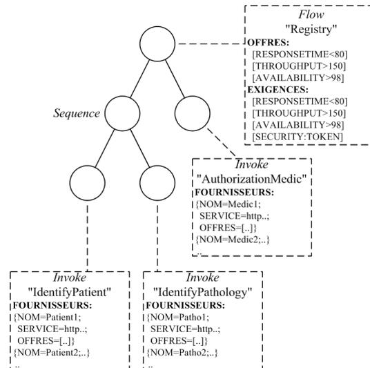
FIGURE 7.4: Sous-arbre issu de la politique « manage\_registry\_qos »
