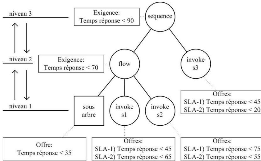
FIGURE 6.4: Exemple de mise en oeuvre de la planification
