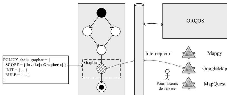
FIGURE 6.6: Exemple de redirection pour l'activité « InvokeGrapher »
