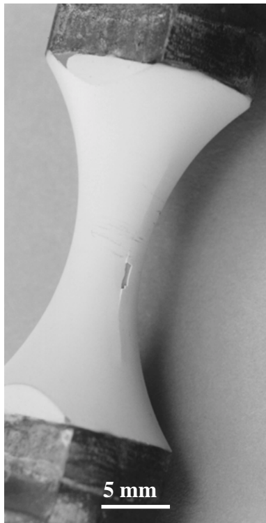
Figure III.18: écaillage après traction monotone à 0,57% de déformation, de l'éprouvette vieillie pendant 8h.
