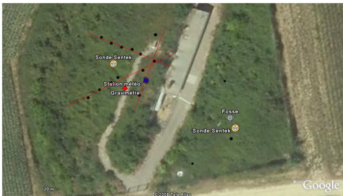
FIG. 7.4 – Positionnement en surface des différents objets mentionnés dans ce travail : Le gravimètre (point rouge), les profils de mesure de teneur en eau Sentek, la fosse où ont été prélevés les échantillons non remaniés de loess, les positions des sondages pénétrométriques sont indiqués en noir.
