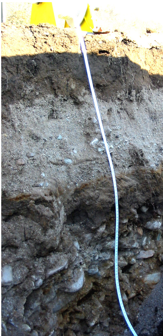
FIG. 6.6 – Photo montrant les deux premiers mètres de remplissage alluvionnaire du fond de la vallée de la Liepvrette. La fosse se situe à 75 m de la rivière
