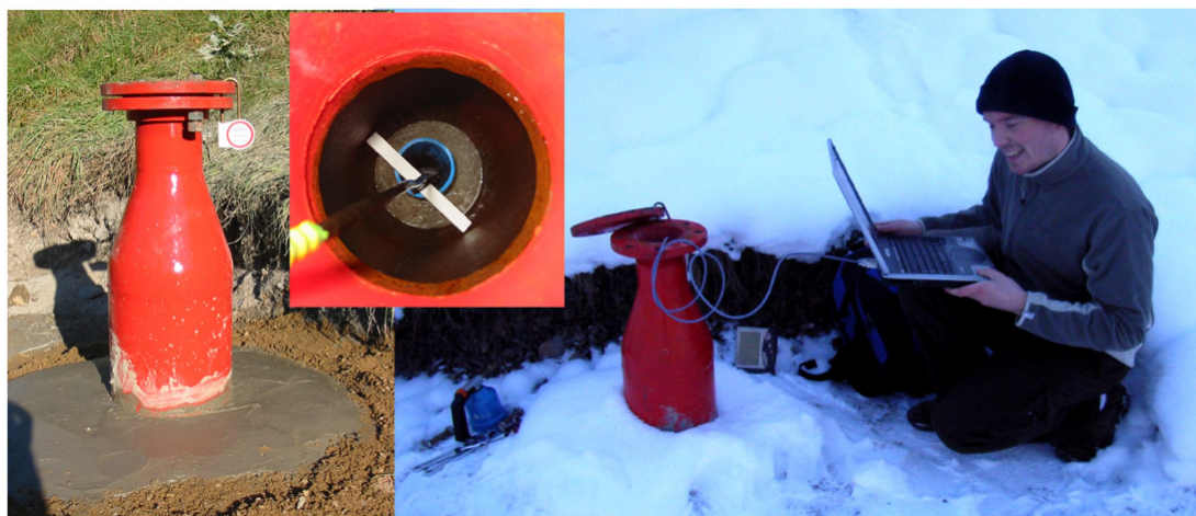
FIG. C.21 – De gauche à droite : Puits dans son environnement, tube piézométrique plongeant, extraction des données hivernales.
