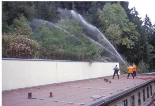
FIG. 5.3 – Test d'arrosage où une lame d'eau de 4 cm a été versée sur le toit de l'observatoire en 20 minutes, d'après Kroner et al. (2004).
