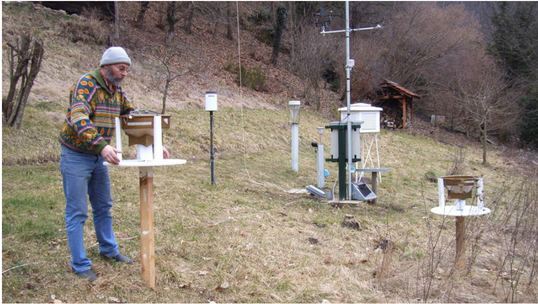
FIG. C.17 – Inter-comparaison pluviomètres. De gauche à droite : Pluviomètre RGR122 modifié par Thierry, le Young, le pluviomètre de référence manuel Météo-France, le pluviomètre Rosted (petite boule noire), la station météo Campbell
