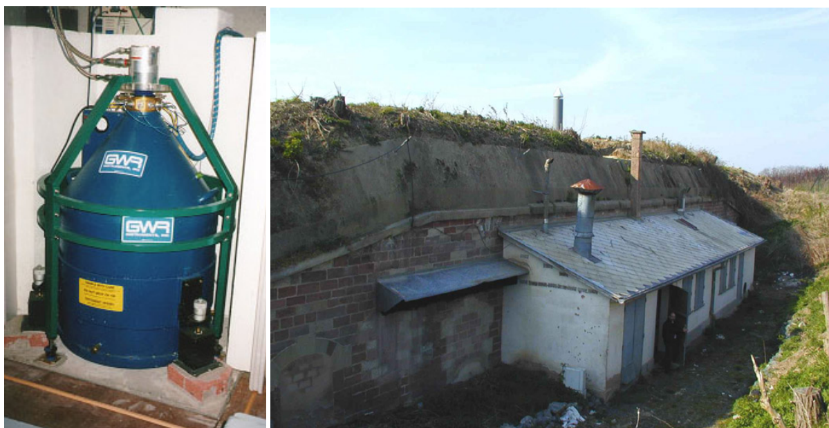
FIG. 2.6 – A gauche, le gravimètre supraconducteur installé à l'observatoire gravimétrique de Strasbourg : Vase Dewar contenant la masse test plongée dans un bain d'hélium liquide à 4,2 K. A droite, ancien fort allemand, construit dans les années 1870, contenant l'instrumentation. A noter la couche de sol qui recouvre le toit du fort.
