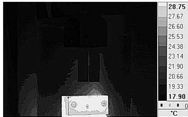
Figure 3.5 – Échauffement du montage en cours d'essai
