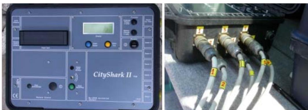
Figure 3. 14 Station d'acquisition des géophones
