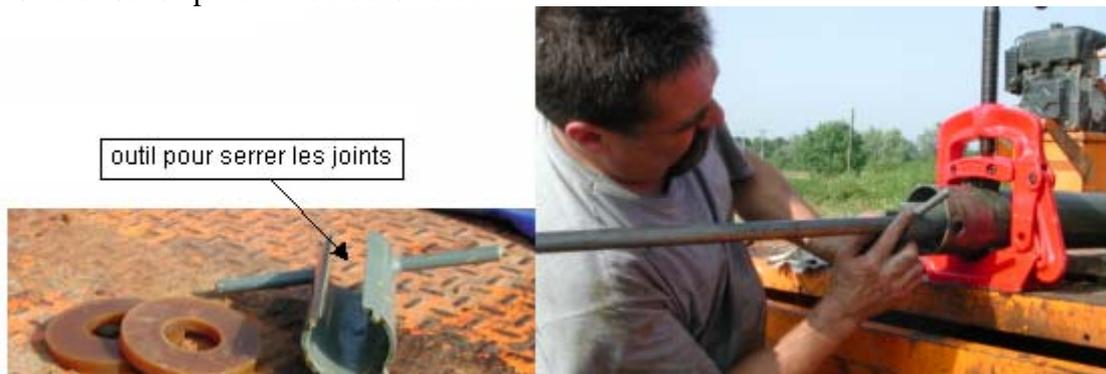
Figure 2.9 Serrage des joints
