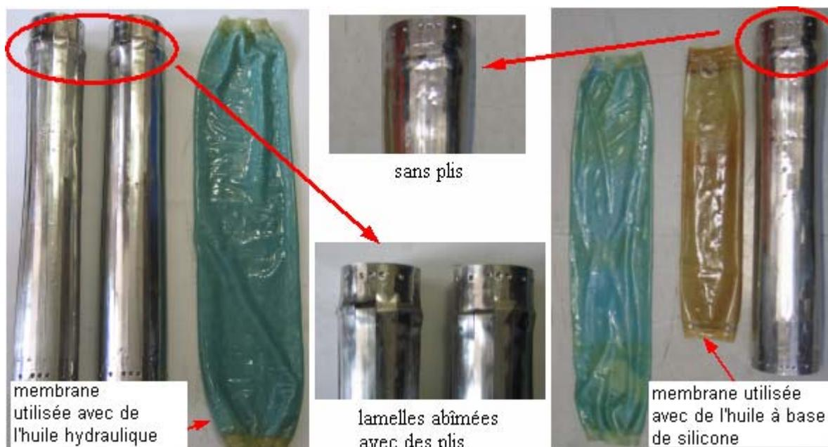
Figure 3. 36 Membrane déformée à cause de l'huile hydraulique
