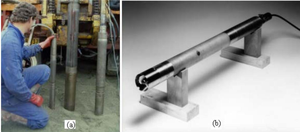
Figure 1. 38 Les différents pressiomètres autoforeur : PAF 68, PAF 76 (a), Camkomètre (b)
