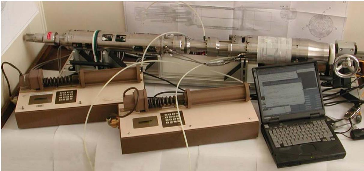
Figure 4. 3 Matériel complet du triaxial *in situ*, avec le support, les deux contrôleurs et l'ordinateur
