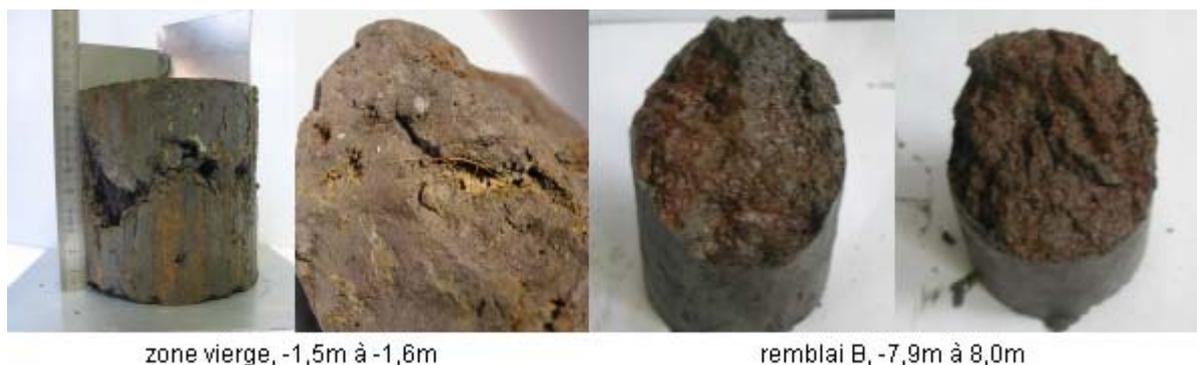
Figure 2. 2 Fibres végétales observées dans les échantillons
