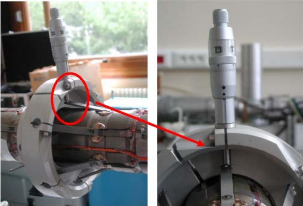
Figure 3. 16 Montage utilisé pour étalonner les palpeurs
