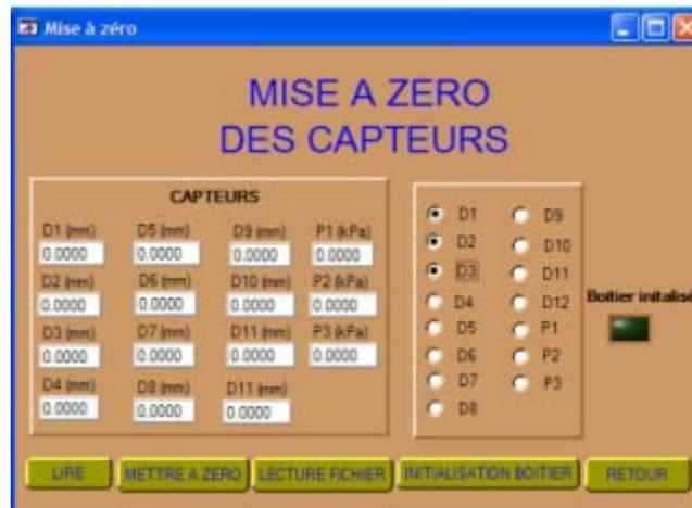
Figure 4. 34 Panneau de mise à zéro des capteurs
