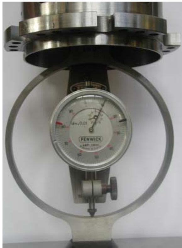
**Figure 4. 24 Étalonnage de la pression réelle du vérin  $P_{\text{vérin}}$  par anneau dynamométrique**
