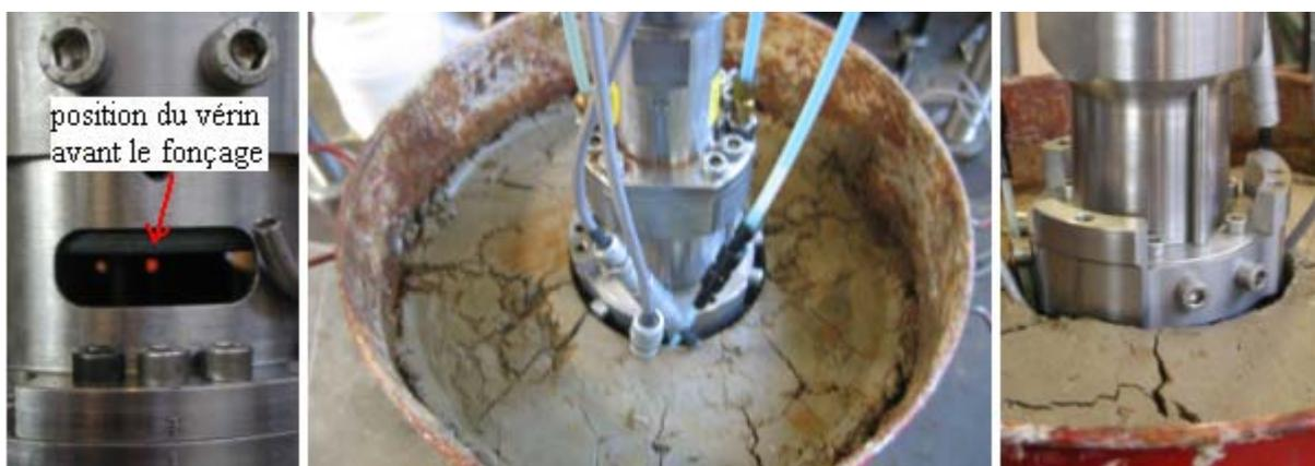
Figure 4. 42 Enfoncement du T.I.S dans le sol
