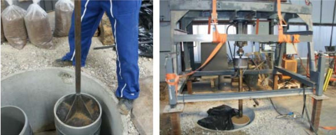
**Figure 3. 8 Réalisation d'une éprouvette et vue d'ensemble du dispositif**
