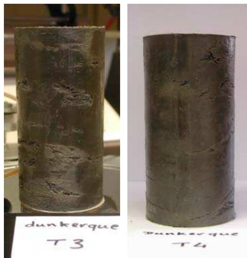
Figure 2-2 : Fissures internes des éprouvettes de l'argile de Dunkerque (d'après Reiffsteck et Tacita, 2008)
