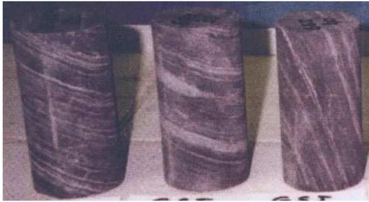
Figure 1-3: Structure anisotrope des éprouvettes de marne noire compacte d'Aspes – Ventavon (d'après Serratrice, 2005).
