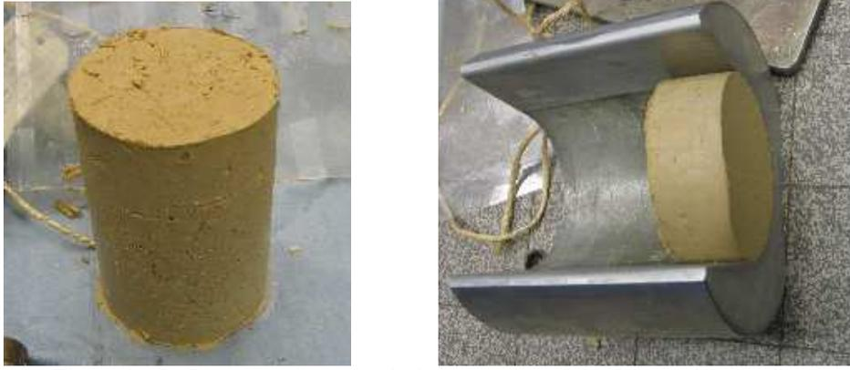
Figure 2-15 : Bloc de mélange après le compactage et tranchage des couches
