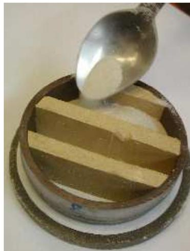
Figure 2-32 : Remplissage du sable dans les éprouvettes de type 2
