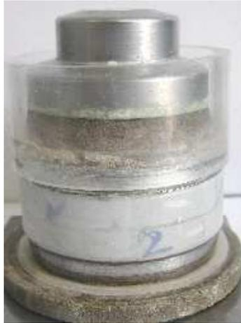
Figure 2-31 : Consolidation d'un bloc de kaolinite.
