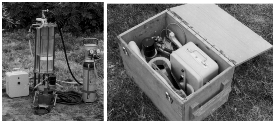
Figure 1.28 : Erodimètre à jet mobile LCPC (Hénensal et al., 1987)
