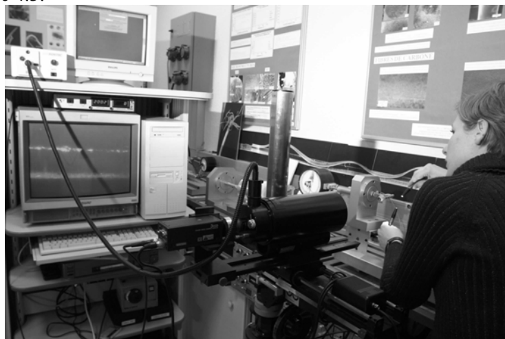
Figure 4.3. : Dispositif optique longue focale permettant le suivi de la déformation transverse, fibre MG.
