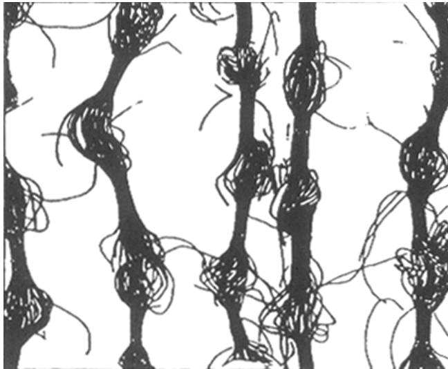
Figure 1.7. : Modèle à cordes de Statton [STA59] . Schématisation de la structure microfibrillaire : alternance de régions ordonnées denses et de régions amorphes. Une ligne symbolise une macromolécule ; l'espace entre microfibrilles est exagéré.
