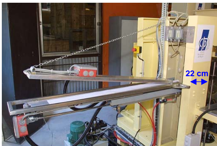
Figure 3. 3 : Vue du système de préchauffage et d'insertion automatique de feuilles
