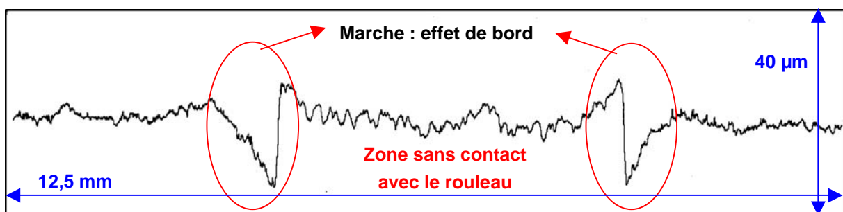
Figure 3. 40 : Profil de rugosité sur le papier F dans la zone de quadrillage (Perthemeter) – Condition de calandrage : cf Figure 3. 39
