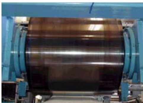
Figure 1.22 : Aspect d'un rouleau avant calandrage ([Carlsson et al. , 2002])
