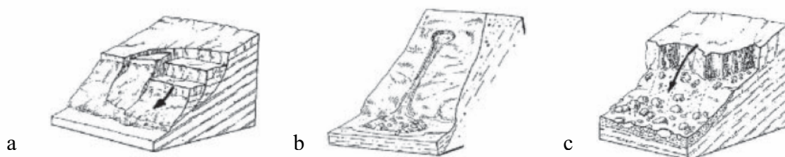
Figure 1. a-glissement; b-écoulement; c-éboulement (Amanti et al, 1992).
