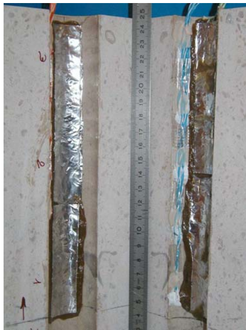
Figure 73. Jauges protégées sur les deux demi-cylindres intérieurs.
