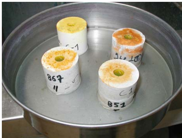
Figure 88. Cylindres de diff rents calcaires, perfor s et remplis d'eau color e.
