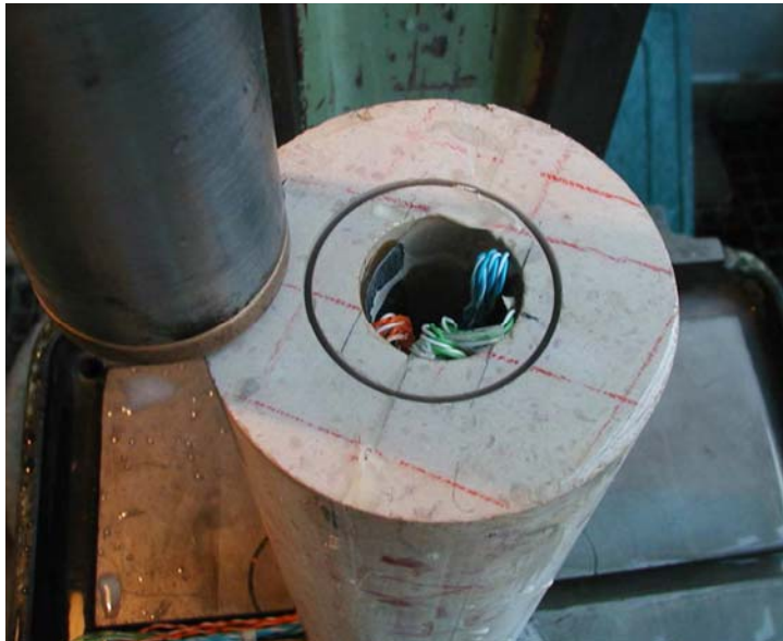
Figure 68. Surcarottage du tube de calcaire.
