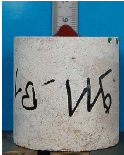
Figure 89. Cylindre avec extrusion de « glace colorée » (cas du Vilhonneur-banc 2).
