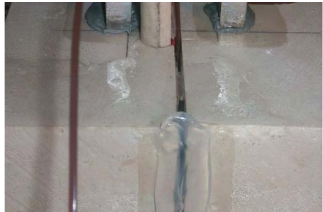
Figure 96. Glace formée de manière inhomogène dans l'entaille du cube de Pierre de Lens.
