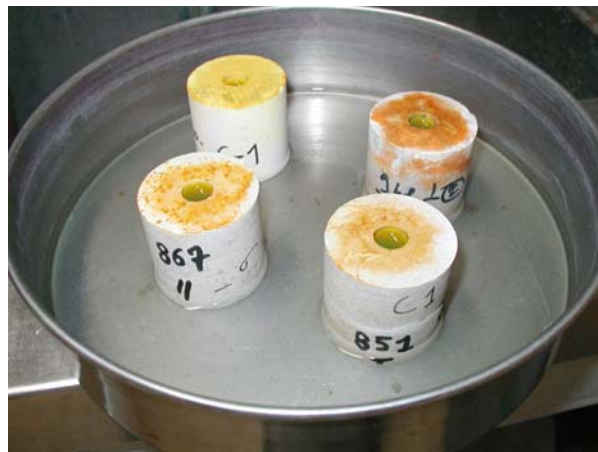
Figure 88. Cylindres de différents calcaires, perforés et remplis d'eau colorée.
