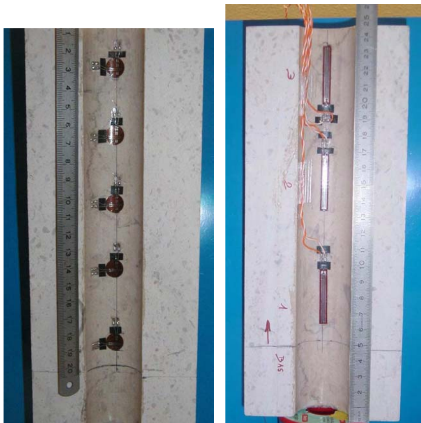
Figure 71. Demi-cylindre instrumenté des 5 jauges bi-axiales (à gauche) & demi-cylindre instrumenté des 3 jauges uni-axiales (à droite), avant reconstitution du tube et surcarottage.
