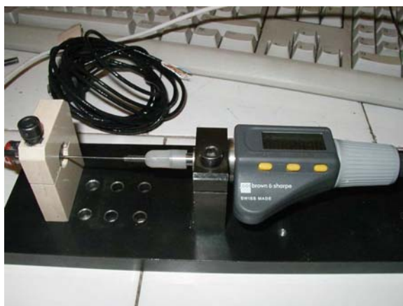
Figure 49. Etalonnage du capteur de déplacement.
