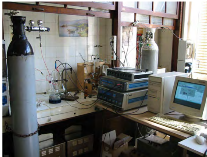
Photo II.3 : Installation pour les mesures d'impédance
