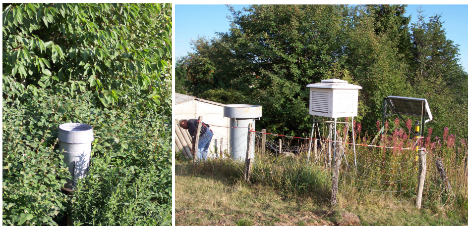
FIG. A.68 – Pluviomètre (hors service) et pluviographe (EDF) à la station des Estables.
