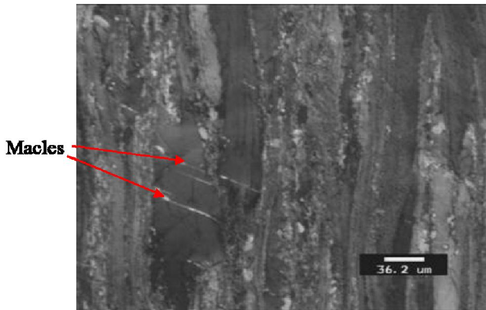
Figure 56 : Microstructure en peau de barre filée à 685°C,  $v_{ref}/10$  et  $\lambda = \lambda_{ref}$ . Direction de mini-filage verticale.
