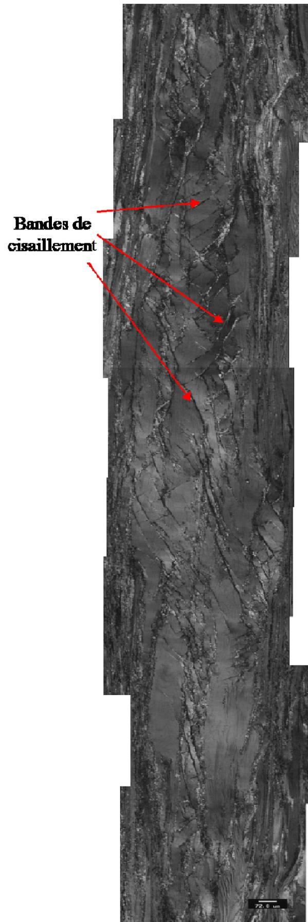
Figure 55 : Microstructure en peau d'une barre filée à 720°C,  $v_{ref}/10$  et  $\lambda = \lambda_{ref}/1,3$ . Direction de mini-filage verticale.
