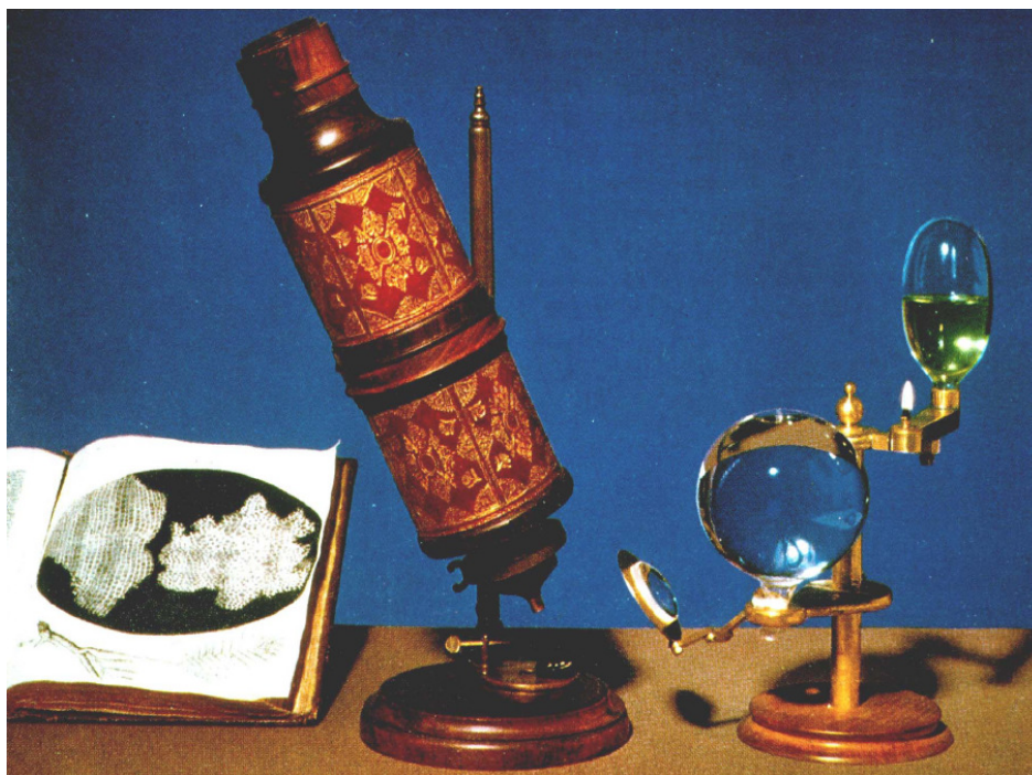
Figure 1-4 : reconstitution du microscope de Hooke. Sur cette photographie, on peut apercevoir à gauche un exemplaire du livre Micrographie . Le microscope de Hooke ressemble à un télescope de l'époque. Il est composé de trois lentilles : une lentille biconvexe (objectif), un oculaire et une lentille de champ. Ces trois composants induisant un certain nombre d'aberrations, Hooke introduisit un diaphragme pour bloquer les rayons les plus paraxiaux. Une grande originalité de ce montage est l'illumination : la lumière générée par une lampe à huile, traverse une flasque de verre remplie d'eau pour diffuser la lumière et obtenir un éclairage plus intense et plus uniforme. C'est le premier condenseur...
