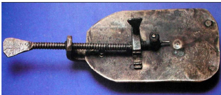
Figure 1-2 : microscope de Van Leeuwenhoek.
