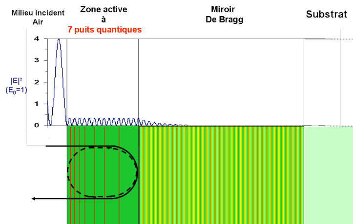
Figure 41 : Etude du module du champ au carré d'une structure anti résonante à 850 nm ; Module carré du champ électrique dans la structure.
