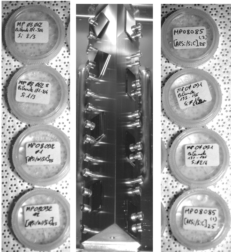
Figure 2.28 : Repérage des échantillons montés sur le support pour les tests de tenue à l'environnement climatique
