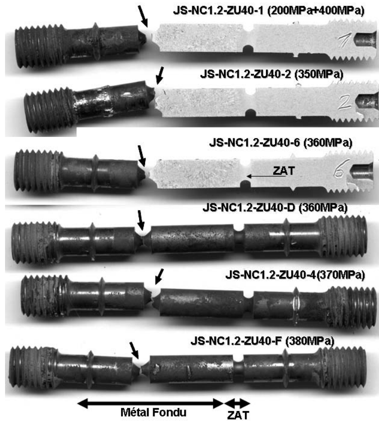
Fig. VI.10 – Zones de rupture des éprouvettes JS-NC1.2-ZU40 fluées à 500°C (CDM)
