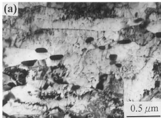
Fig. III.67 – Micrographie TEM d'un Joint Soudé de Fe-9Cr-1Mo modifié ayant subi un PWHT à 750^{\circ}\text{C}/1\text{h} (SHIUE et al., 2000)
