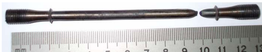
Fig. VI.1 – Rupture dans le Métal de Base d'une éprouvette de Joint Soudé (500°C, \dot{\epsilon} = 10^{-5} s^{-1} )
