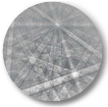
Fig. A.5 – Exemple d'un cliché de diffraction avec ses pseudos-bandes de Kikuchi (Source : http://www.edax.com/products/tsl.cfm )
