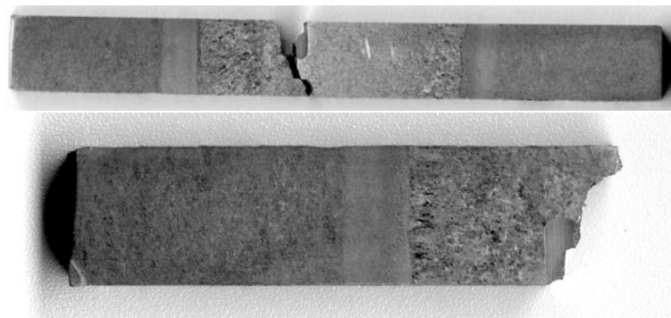
Fig. V.43 – Eprouvette de Métal Fondu testée par choc, Attaque au réactif Villela
