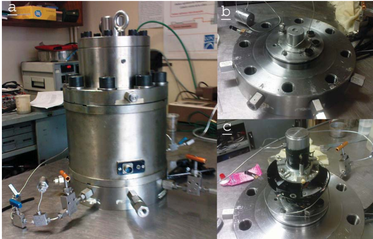
Figure 2-3- (a) Vue de l'extérieur de la cellule triaxiale ; (b) La partie inférieure de la cellule ; (c) Vue d'une éprouvette avec l'installation des anneaux et les instrumentations
