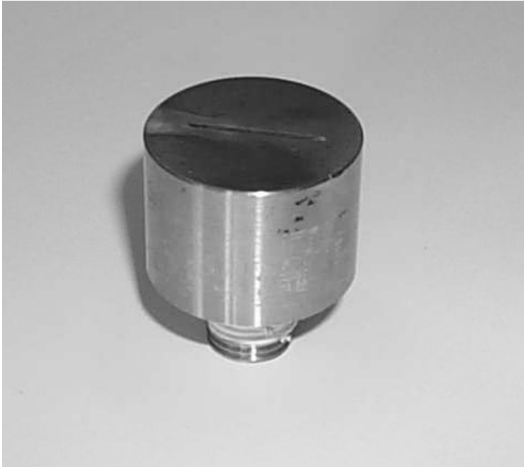
FIG. 4.7 – Photographie de la buse rectangulaire et supersonique de 20 mm.
