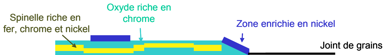
Figure 5.33: Représentation schématique des fissures secondaires caractérisées par MET
