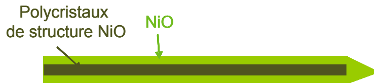
Figure 5.35: Représentation schématique des fissures intragranulaires caractérisées par MET
