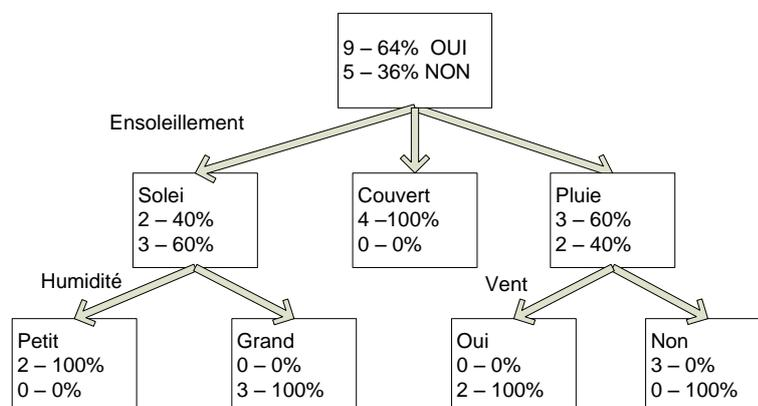
**FIGURE 2.5: L'exemple d'un arbre de décision** - L'algorithme d'apprentissage cherche à produire des groupes d'individus les plus homogènes possible du point de vue de la variable à prédire à partir des variables de météo.
