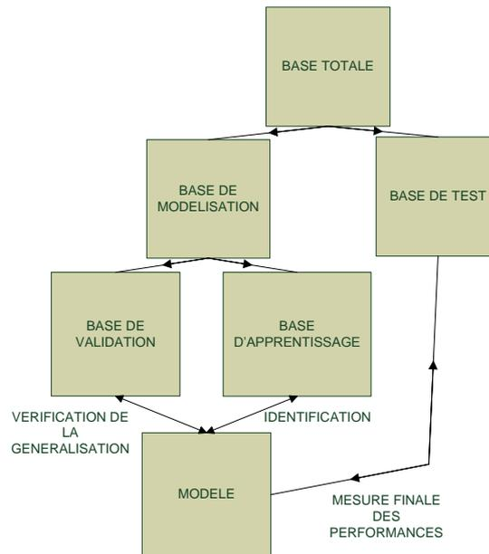
FIGURE 2.1: Processus de validation par le test -
