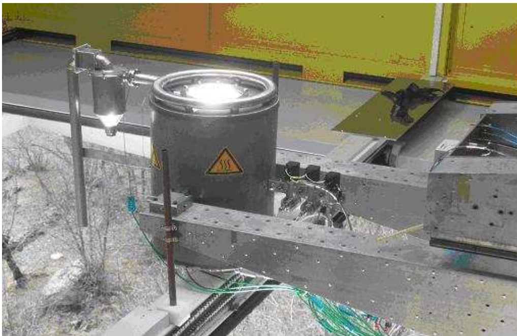
Figure 66- Vue d'ensemble du récepteur réalisé durant son fonctionnement
