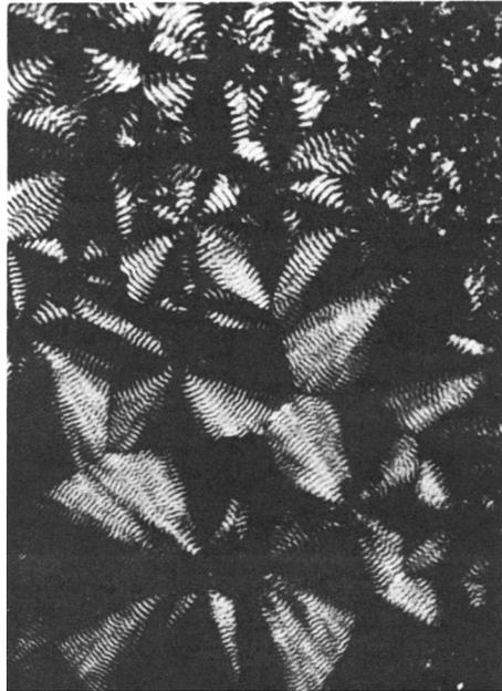
FIGURE 1.14 – Observation des sphérolites du PA 11 en lumière polarisée avec polariseur et analyseur croisés (Magill 1969).
