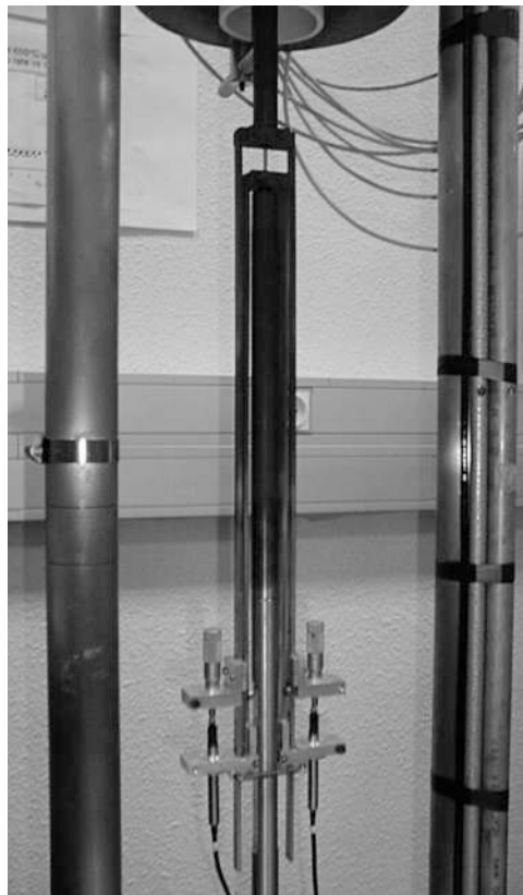
Figure A2-3 : Extensomètre utilisé pour les essais de relaxation.
