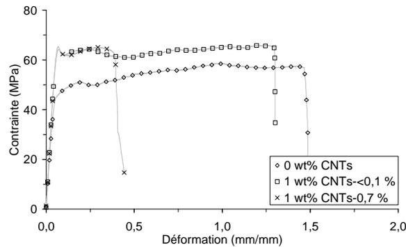
Figure 3-24 : Courbes de traction des composites PA6<sup>15</sup>-0NT-200 (◇), PA6<sup>15</sup>-1NT-200 (□) et PA6<sup>15</sup>-1NT-100 (×). Le pourcentage dans la légende est le  $S_{CNTs}$  (%).
