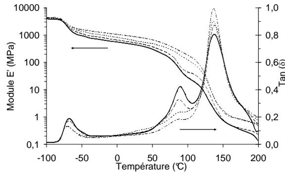
Figure 5-21 : Analyse dynamique mécanique (module  $E'$  et  $\tan(\delta)$ ) des composites  $S_{14}^{11}B_{19}M_{67}$ -NT-100 avec différentes concentrations en CNTs 0 wt% (—), 1 wt% (— —), 5 wt% (— — —), 10 wt% (— — —).
