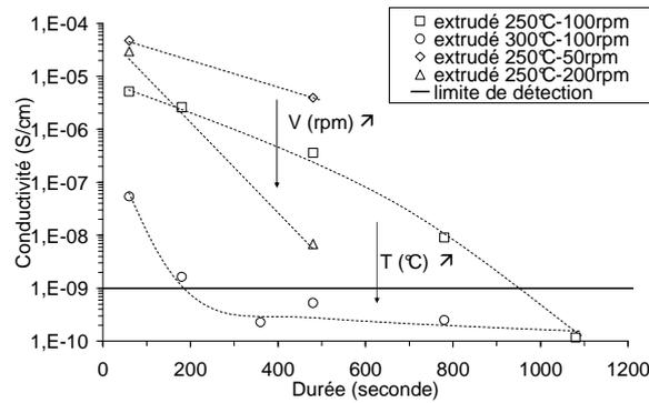
Figure 6-17 : Conductivité du composite PA6<sup>15</sup>-3NT-9S<sub>36</sub><sup>15</sup>B<sub>11</sub>M<sub>53</sub>-100 en fonction de la température et du temps d'extrusion après un traitement thermique à 250 °C.
