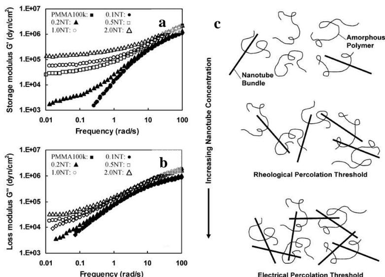
Figure 1-31 : a) Module  $G'$  b) Module  $G''$  en fonction de la fréquence pour des composites PMMA/SWNTs avec différents taux de charges c) Schéma d'une distribution isotrope des CNTs dans un composite (haut) Schéma de la percolation rhéologique due à une distance entre CNTs inférieure rayon de giration de la chaîne (milieu), Schéma de la percolation électrique due au contact entre CNTs (bas).<sup>121</sup>
