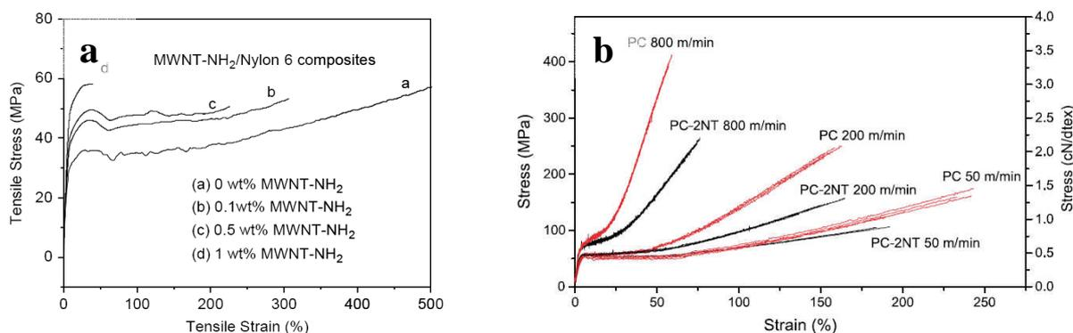
Figure 1-15 : a) Contrainte en fonction de la déformation pour un composite PA-6/MWNTs greffé NH<sub>2</sub> avec différents pourcentage des MWNTs<sup>62</sup> b) Contrainte en fonction de la déformation pour des fibres de polycarbonate avec 2 wt% de MWNTs pour différents étirements.<sup>70</sup>
