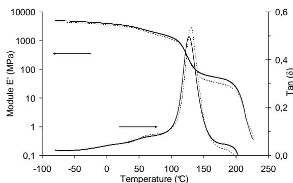
Figure A7-6 : Analyse dynamique mécanique (module E' et tan (δ)) des composites PMMA<sub>5</sub>-30PA6<sup>2.5</sup> (—) et PMMA<sub>5</sub>-1NT-30PA6<sup>2.5</sup> (---).
