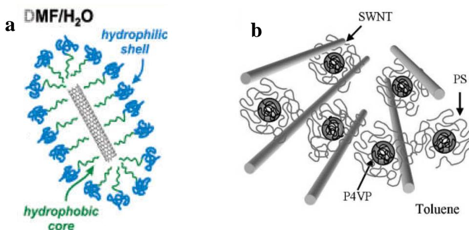
Figure 1-12 : Schéma de la nanostructure des CNTs et de copolymère à blocs a) copolymère formant un couronne autour des SWNTs<sup>46</sup> b) Micelle de copolymère à blocs accrochée au SWNTs.<sup>47</sup>
