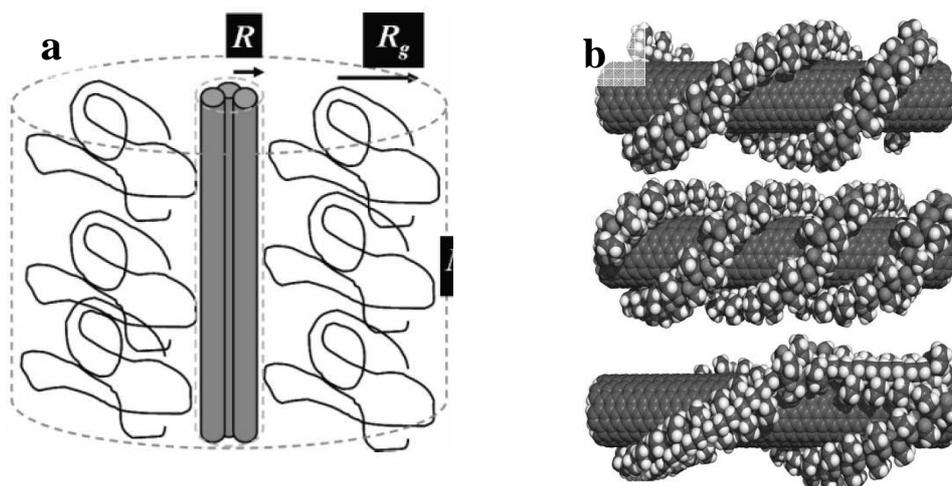
Figure 1-10 : Structuration possible des polymères à la surface des CNTs a) Structuration de chaîne aléatoire<sup>42</sup> b) Structuration hélicoïdale.<sup>43</sup>
