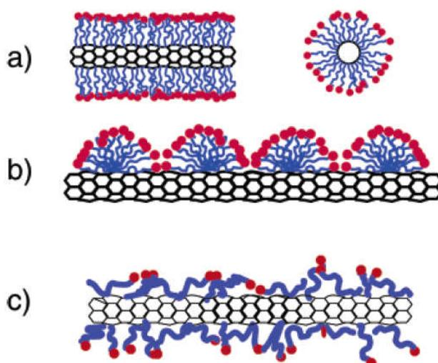
Figure 1-8 : Représentation possible de l'organisation des surfactants à la surface des CNTs a) Organisation en cylindre, b) Organisation en hemimicelles, c) Couche adsorbée aléatoire non organisée.<sup>40</sup>
