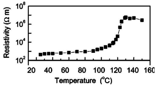
Figure 1-27 : Courbe de la résistivité en fonction de la température pour un composite MWNT/HDPE.<sup>111</sup>
