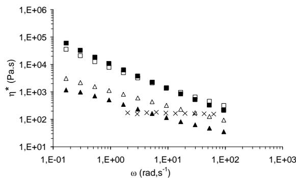
Figure 6-7 : Viscosité du PA6<sup>15</sup> (×) et des SBM le  $S_{24}^{11}B_{31}M_{45}$  (■) et le  $S_{36}^9B_{11}M_{53}$  (▲) mesurée à 250 °C. Dans la légende les symboles pleins correspondent aux SBM non purifiés et les symboles vides aux SBM purifiés.
