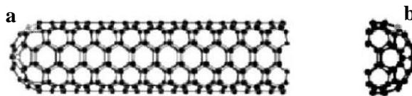
Figure 1-1 : a) Schéma d'un nanotube de carbone mono parois b) Schéma d'un demi-fullerène.<sup>2</sup>
