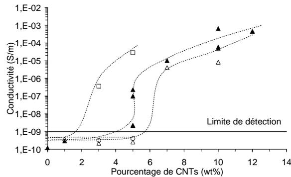
Figure 6-15 : Conductivité des composites PA6<sup>15</sup>-NT-100 (▲), PA6<sup>15</sup>-NTp-200 (△), PA6<sup>15</sup>-NT-S<sub>36</sub><sup>15</sup>B<sub>11</sub>M<sub>53</sub>-100 (□), PA6<sup>15</sup>-NT-PA6<sup>15</sup>-100 (○).
