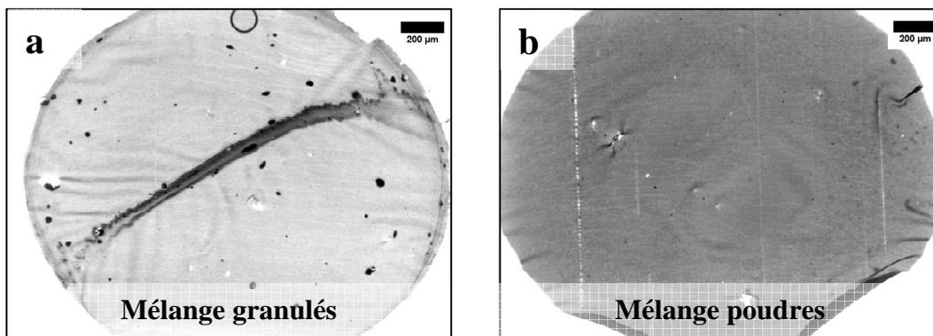
Figure 5-11 : Image en microscopie optique a) S<sub>14</sub><sup>11</sup>B<sub>19</sub>M<sub>67</sub>-10NT-200 (S<sub>CNTs</sub> = 0.6 %) b) S<sub>14</sub><sup>11</sup>B<sub>19</sub>M<sub>67</sub>-10NTp-200 (S<sub>CNTs</sub> < 0.1 %).
