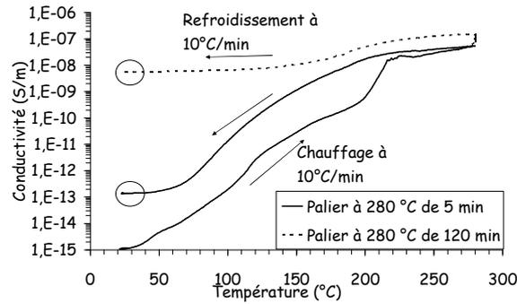
Figure 4-13 : Evolution de la conductivité pour un composite PA6<sup>15</sup>-3NT-200 en fonction de la température pour différents paliers à 280 °C.
