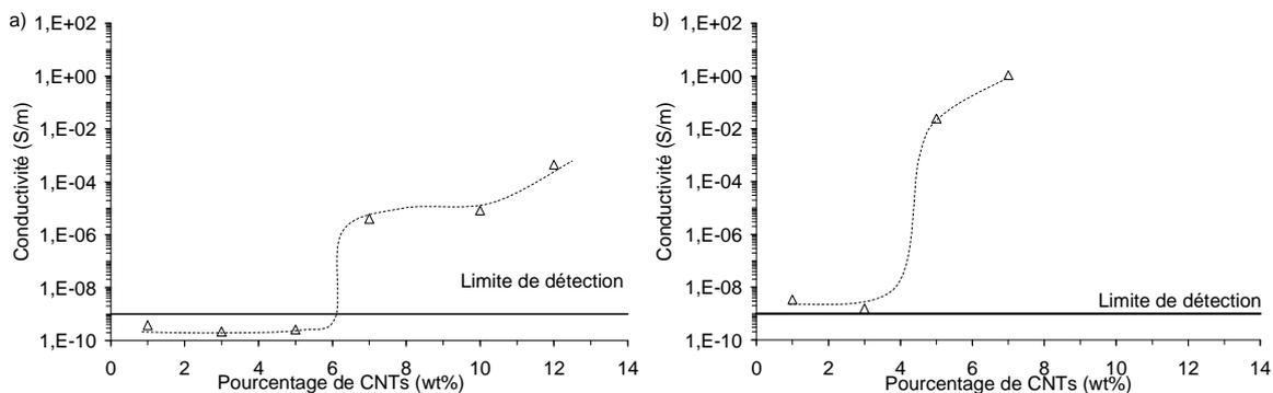
Figure 4-1 : Conductivité pour les composite a) PA-6/CNTs (PA6<sup>15</sup>-NTp-200)
