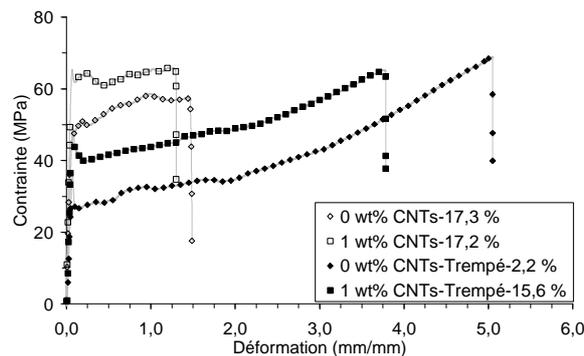
Figure 3-23 : Courbes de traction des composites PA6<sup>15</sup>-0NT-200 et PA6<sup>15</sup>-1NTp-200 après une trempe et un refroidissement à « vitesse modérée », le pourcentage dans la légende est le taux de cristallinité.
