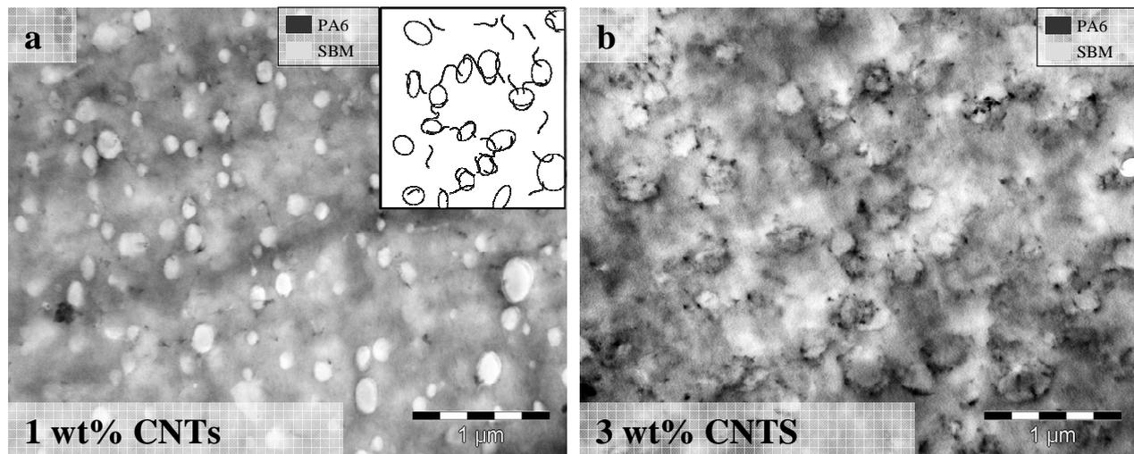
Figure A5-1 : Image TEM des composite a) PA6<sup>15</sup>-1NT-9S<sub>36</sub><sup>15</sup>B<sub>11</sub>M<sub>53</sub>-100 b) PA6<sup>15</sup>-3NT-9S<sub>36</sub><sup>15</sup>B<sub>11</sub>M<sub>53</sub>-100. (Marquage : acide phosphotungstique)
