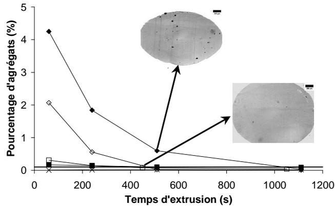
Figure 6-1: Pourcentage d'agrégats en fonction de la durée d'extrusion pour les composites PA6<sup>15</sup>-1NT-100 (◆), PA6<sup>15</sup>-1NT-200 (◇), PA6<sup>15</sup>-1NT-9S<sub>14</sub><sup>11</sup>B<sub>19</sub>M<sub>67</sub>-100 (■), PA6<sup>15</sup>-1NT-9S<sub>14</sub><sup>11</sup>B<sub>19</sub>M<sub>67</sub>S-100 (□) et PA6<sup>15</sup>-1NT-9PA6<sup>15</sup>-100 (×).
