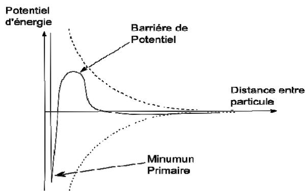
Figure 1-9 : Potentiel d'énergie entre deux particules colloïdales.
