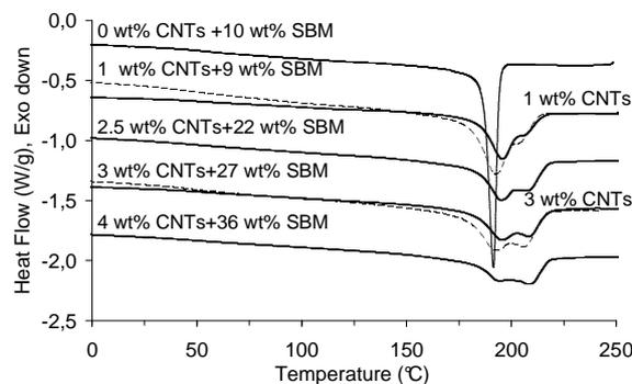
Figure 6-10 : Thermogrammes au refroidissement pour différents composites PA615-NT-200 (— —) et PA615-NT-S<sub>14</sub><sup>11</sup>B<sub>19</sub>M<sub>67</sub>S-100 (—). Les pourcentages massiques des CNTs et du SBM sont marqués sur la figure. ( $v = 10 \text{ °C/min}$ )
