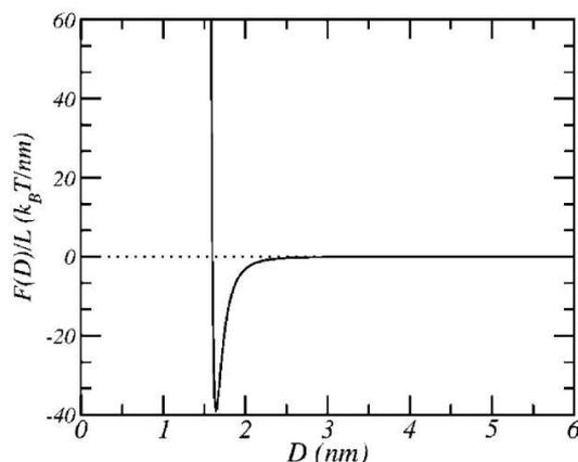
Figure 1-6 : Potentiel d'interaction par unité de longueur entre deux SWNTs parallèles en fonction de la distance inter-tube.<sup>25</sup>
