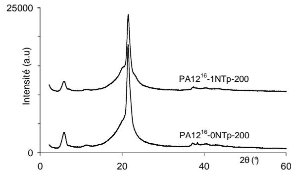
Figure 3-20 : Diffractogrammes WAXS des composites PA12<sup>16</sup>-0NTp-200 et PA12<sup>16</sup>-1NTp-200.
