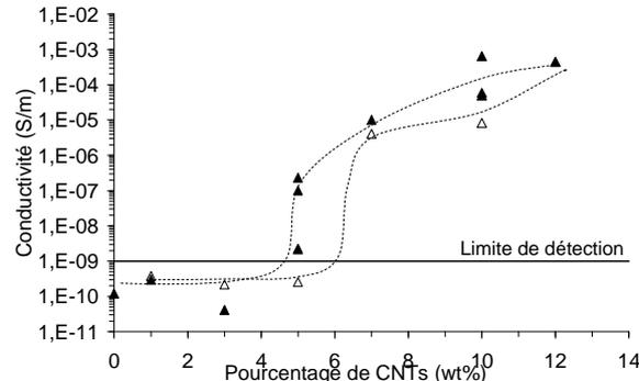
Figure 4-16 : Conductivité pour les composites PA6<sup>15</sup>-NT à différentes vitesse d'extrusion 100 rpm (▲) et 200 rpm (△) en fonction du pourcentage de CNTs.
