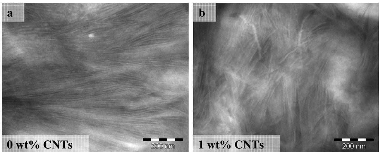
Figure 3-19 : Images TEM des composites a) PA12<sup>16</sup>-0NT b) PA12<sup>16</sup>-1NT (Coupe parallèle-
