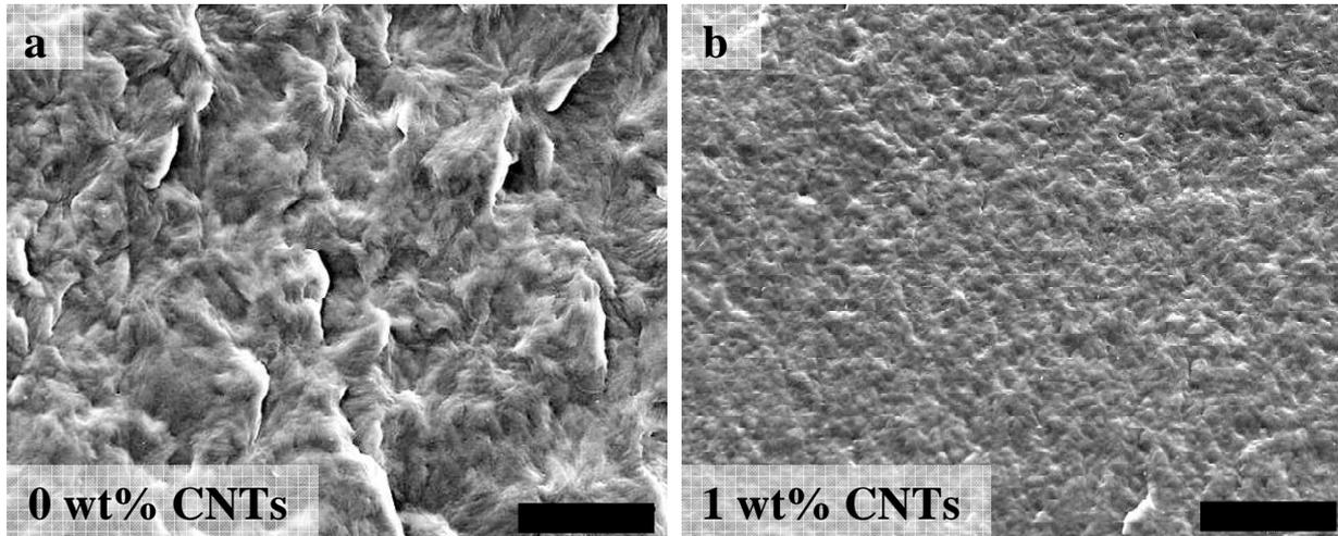
Figure 3-13 : Images MEB des composites a) PA6<sup>15</sup>-0NT-200 b) PA6<sup>15</sup>-0.1NTp-200 –(barre d'échelle : 5  $\mu$ m)
