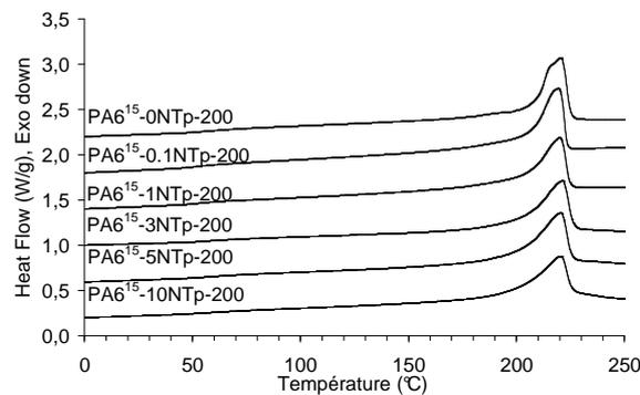
Figure 3-10 : Thermogrammes des composites PA6<sup>15</sup>-NTp-200 avec différents taux de charges au 2<sup>ème</sup> chauffage. ( $v = 10$  °C/min)
