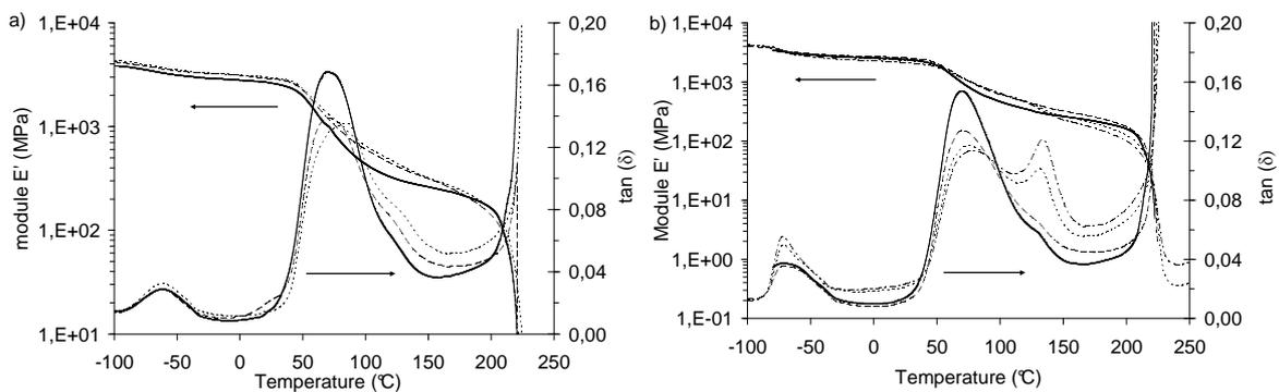
Figure 6-21 : Analyse dynamique mécanique (module  $E'$  et  $\tan(\delta)$ )
