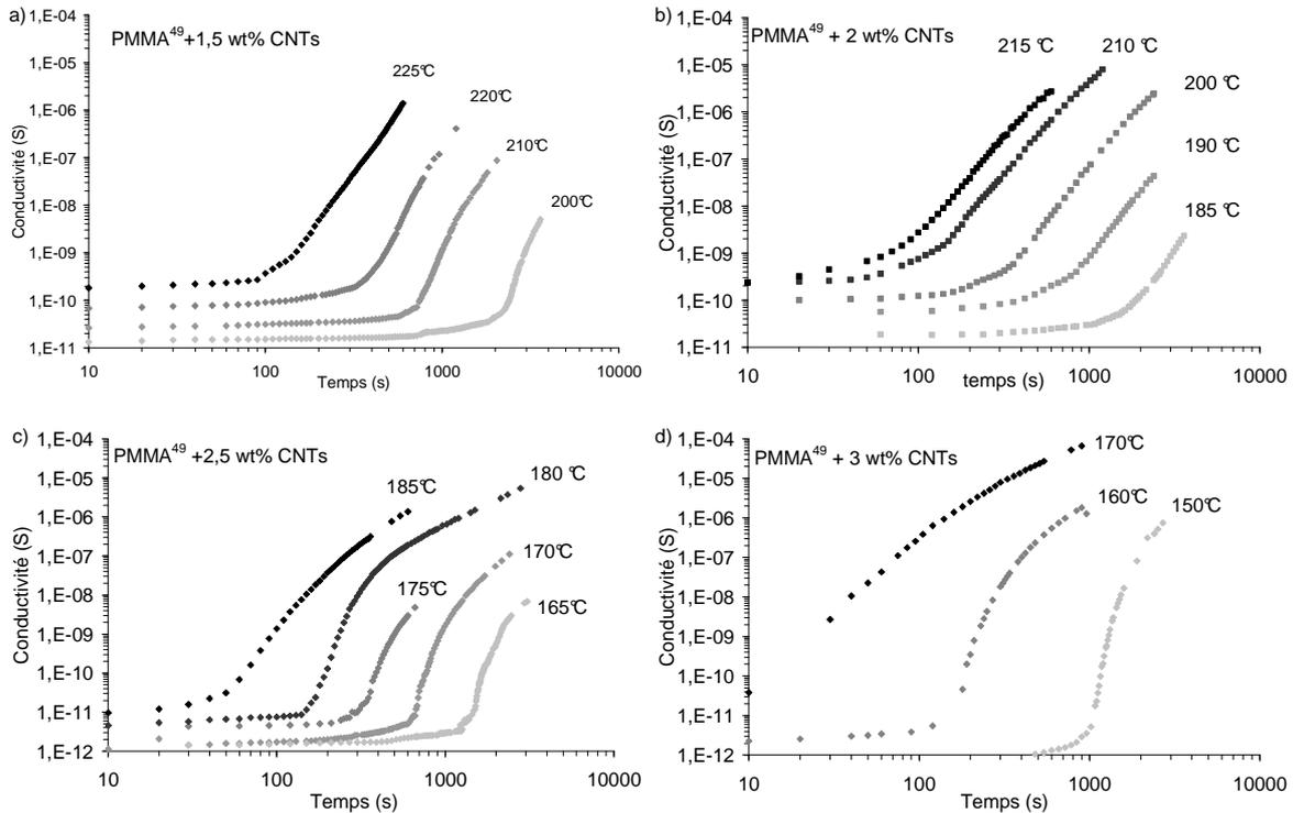
Figure 4-9 : Evolution de la conductivité isotherme avec le temps pour le composé PMMA<sup>49</sup>-NT-200 à différentes températures et à différentes concentrations en CNTs a) 1.5 wt%, b) 2 wt%, c) 2.5 wt%, d) 3 wt%.
