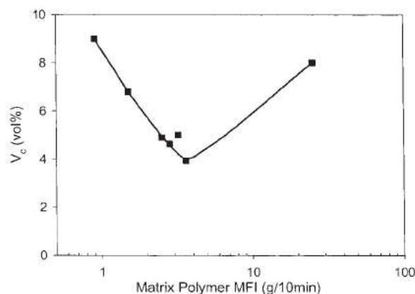
Figure 1-26 : Relation entre le MFI de la matrice et le seuil de percolation pour des composites de polyoléfines/CB.<sup>104</sup>
