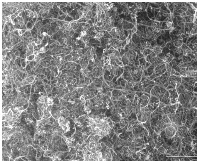
Figure 0-2 : Image MEB de nanotubes de carbone bruts.
