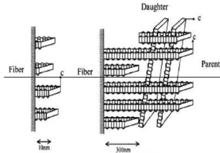
Figure 1-34 : Orientation des lamelles cristallines de PP à la surface des fibres de PP.<sup>131</sup>
