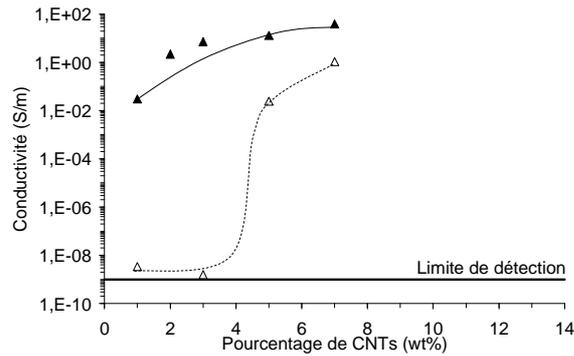
Figure 4-3 : Conductivité pour le composite PMMA/CNTs (PMMA<sup>49</sup>-NTp-200) à deux températures de mise en forme différentes 190 °C (△), 250 °C (▲).
