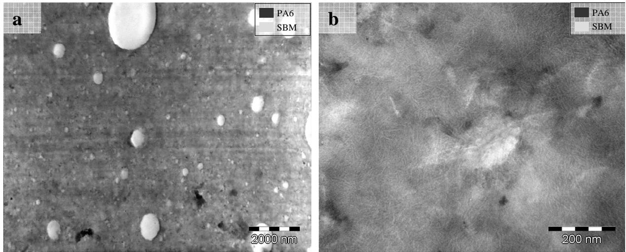
Figure 6-19 : Image TEM du composite PA6<sup>15</sup>-3NT-9S<sub>23</sub><sup>5</sup>B<sub>7</sub>M<sub>70</sub>-100 avec deux grandissements différents en coupe // (Marquage: acide phosphotungstique)
