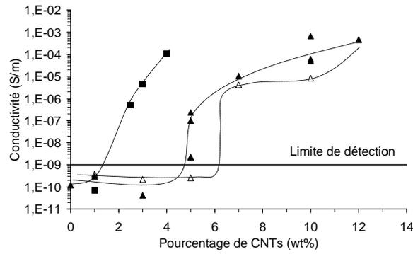
Figure 6-13 : Conductivité des composites de PA6<sup>15</sup>-NT-100 (▲), PA6<sup>15</sup>-NTp-200 (△), PA6<sup>15</sup>-NT-S<sub>14</sub><sup>11</sup>B<sub>19</sub>M<sub>67</sub>S-100 (■).
