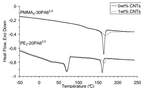
Figure A7-5 : Thermogrammes au refroidissement des composites PMMA<sub>5</sub>-30PA6<sup>2.5</sup> et PE<sub>2</sub>-20PA6<sup>2.5</sup> avec 0 et 1 wt% de CNTs. (v = 10 °C/min)
