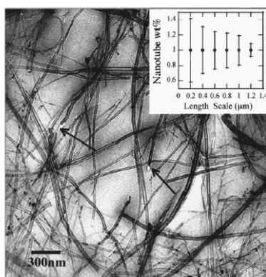
Figure 1-17 : Image TEM d'un composite PS/MWNT. <sup>83</sup>
