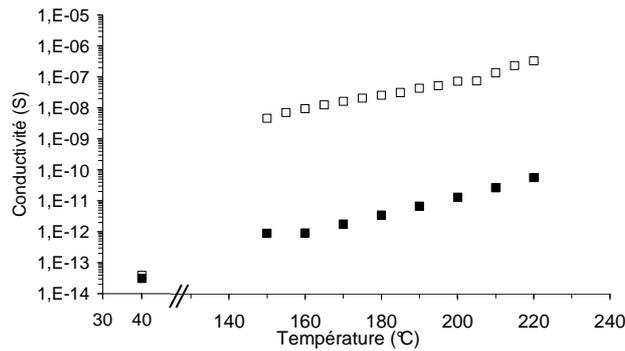
Figure 4-12 : Evolution de la conductivité avec la température pour le PMMA<sup>49</sup> (■) et le PA6<sup>15</sup> (□).
