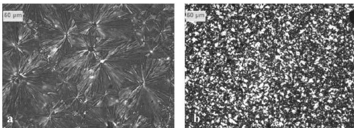
Figure 1-32 : Image de microscopie optique a) du polypropylène pur b) polypropylène avec 1 wt% de MWNTs.<sup>123</sup>
