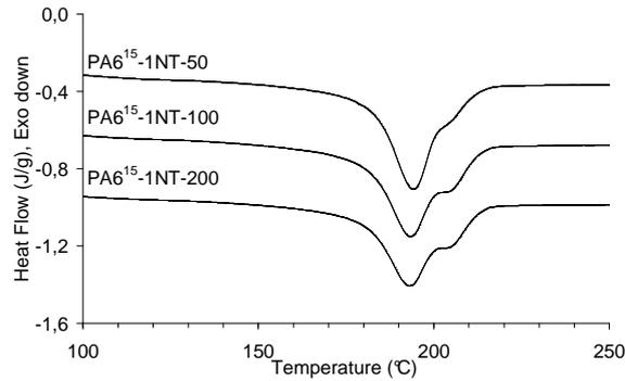
Figure 3-8 : Thermogrammes au refroidissement des composites PA6<sup>15</sup>-1NT extrudés à différentes vitesses. ( $v = 10 \text{ }^\circ\text{C/min}$ )
