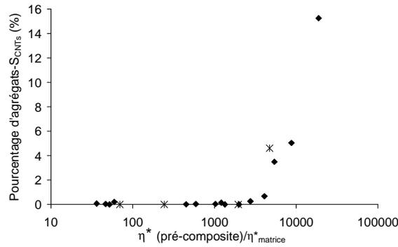
Figure 6-23 : Pourcentage d'agrégats des composites PMMA-3NT-9SBM (\*) et PA6-3NT-9SBM (♦) en fonction du rapport des viscosités.
