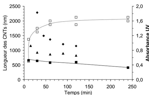
Figure 5-2 : Longueur des CNTs pour une puissance de 20 (◆)<sup>3</sup>, 40 (▲)<sup>3</sup>, et 105 (■) W et absorbance UV-visible (□) pour nos essais à 105 et 200 W.
