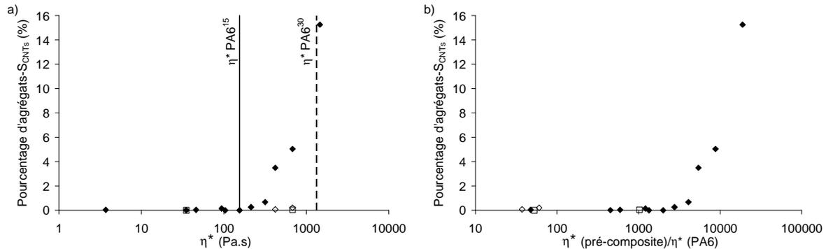
Figure 6-5 : Pourcentage d'agrégats des composites PA6<sup>15</sup>-3NT-9SBM (◆), PA6<sup>15</sup>-3NT-27SBM (◇), PA6<sup>30</sup>-3NT-9SBM (□) en fonction de a) la viscosité du SBM b) du rapport des viscosités du pré-composite et de la matrice.
