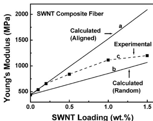
Figure 1-18 : Module d'Young expérimental et calculé avec le modèle de Haplin-Tsai pour des fibres alignées et isotropes.<sup>64</sup>
