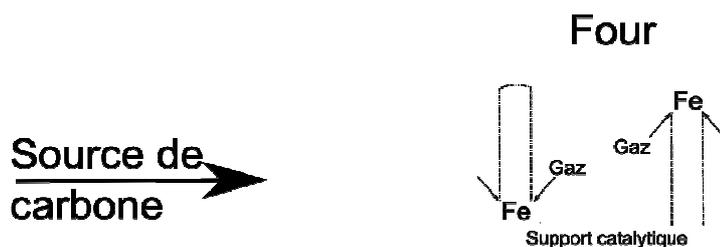
Figure 2-1 : Schéma de croissance des CNTs au cours de la synthèse par CCVD.
