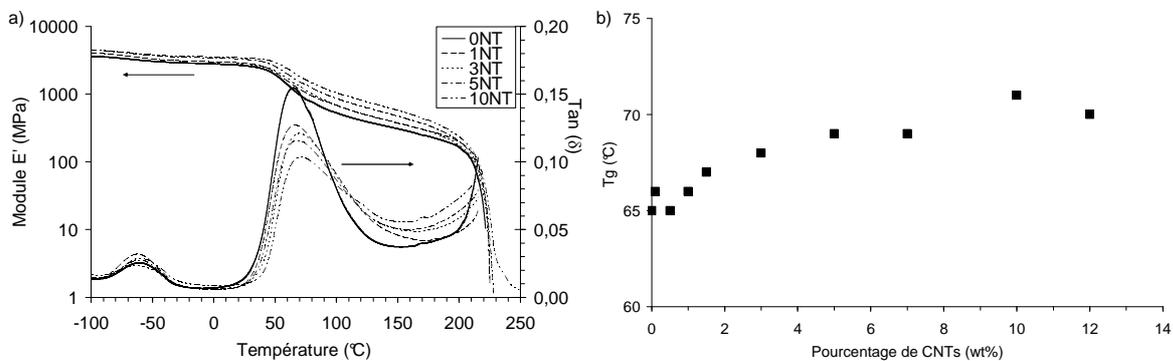
Figure 3-25 : Courbe de DMA des composites PA6<sup>15</sup>-NT-200 pour différents pourcentages de CNTs b) Evolution de la  $T_g$  en fonction du pourcentage en CNTs.
