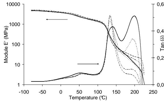
Figure A7-13 : Analyse dynamique mécanique (module  $E'$  et  $\tan(\delta)$ ) des composites  $\text{PMMA}_2\text{-30PA6}^{15}$  (—),  $\text{PMMA}_2\text{-1NT-30PA6}^{15}$  (----),  $\text{PMMA}_7\text{-30PA6}^{15}$  (— —),  $\text{PMMA}_7\text{-1NT-30PA6}^{15}$  (— — —).
