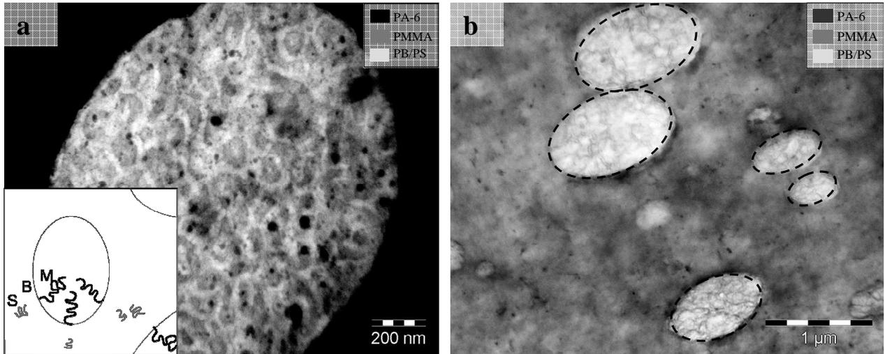
Figure 6-9 : Image TEM du composite PA6<sup>15</sup>-1NT-9S<sub>14</sub><sup>11</sup>B<sub>19</sub>M<sub>67</sub>S-100 a) Nodule de SBM (Marquage : acide phosphotungstique, 2 min 60 °C) b) Vue générale (Marquage : acide phosphotungstique, 1 min, 25 °C)
