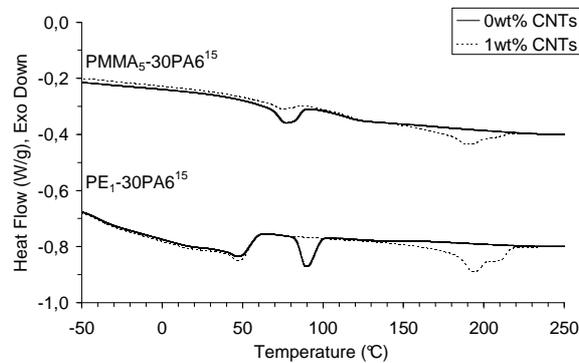
Figure A7-8 : Thermogrammes au refroidissement des composites PMMA<sub>5</sub>-30PA6<sup>15</sup> et PE<sub>1</sub>-30PA6<sup>15</sup> avec 0 et 1 wt% de CNTs. ( $v = 10 \text{ }^\circ\text{C}/\text{min}$ )
