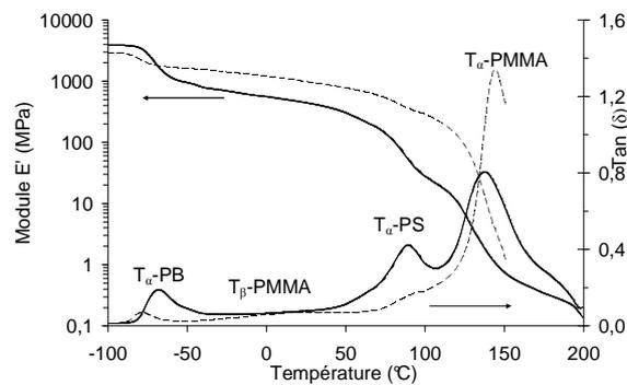
Figure 5-19 : Analyse dynamique mécanique (module E' et tan ( $\delta$ )) du S<sub>14</sub><sup>11</sup>B<sub>19</sub>M<sub>67</sub> préparé par voie solvant (—) et par voie fondu (——).
