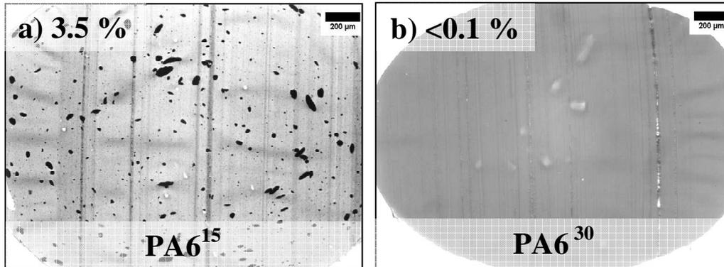
Figure 6-4 : Photos de microscopie optique d'un mélange PA6-3NT-9S<sub>14</sub><sup>11</sup>B<sub>19</sub>M<sub>678</sub>-100 avec a) PA6<sup>15</sup> b) PA6<sup>30</sup>. Le nombre dans l'insert correspond au S<sub>CNTs</sub> (%).
