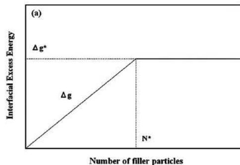
Figure 1-20 : Courbe de l'excès d'énergie interfaciale en fonction du nombre de particules.<sup>92</sup>
