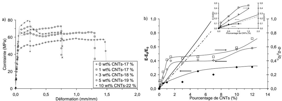
Figure 3-21 : a) Courbes de traction des composites PA6<sup>15</sup>-NTp-200, le pourcentage dans la légende est le taux de cristallinité.
