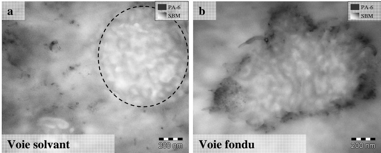
Figure 6-11 : Image TEM des composite a) PA6<sup>15</sup>-1NT-9S<sub>14</sub><sup>11</sup>B<sub>19</sub>M<sub>67</sub>S-100 b) PA6<sup>15</sup>-1NT-9S<sub>14</sub><sup>11</sup>B<sub>19</sub>M<sub>67</sub>-100 extrudé 1 min. (Pas de Marquage)
