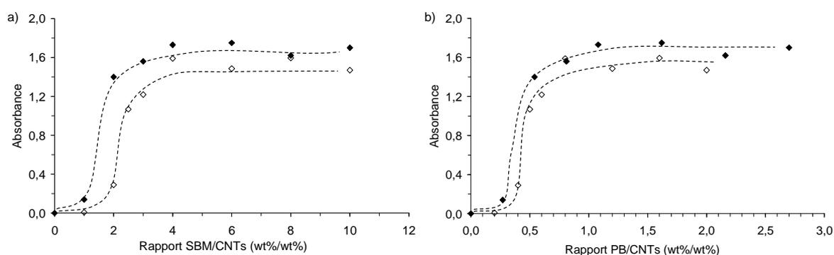
Figure 5-7 : Absorbance UV-visible pour le  $S_{14}^{11}B_{19}M_{67}$  brut (◆) et purifié (◇) a)-en fonction du rapport massique SBM/CNTs b)-en fonction du rapport massique PB/CNTs.
