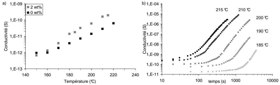
Figure 4-8 : Mesures de la conductivité à différentes températures a) conductivité aux temps courts  $\sigma_{t=0s}$  en fonction de la température pour les composites PMMA<sup>49</sup>-0NT et PMMA<sup>49</sup>-2NT b) évolution de la conductivité avec le temps, pour différentes températures pour le composite PMMA<sup>49</sup>-2NT.
