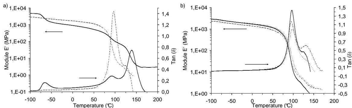
Figure A4-2 : Analyse dynamique mécanique (module  $E'$  et  $\tan(\delta)$ )
