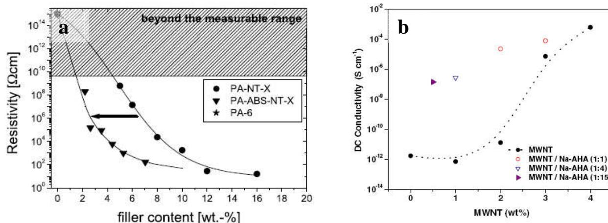
Figure 1-30 : a) Comparaison des résistivités et seuil de percolation pour une dispersion dans le PA-6 et dans un alliage PA-6/ABS.<sup>119</sup> b) Comparaison des résistivités et seuil de percolation pour une dispersion dans le PA-6 seul et avec Na-AHA.<sup>120</sup>
