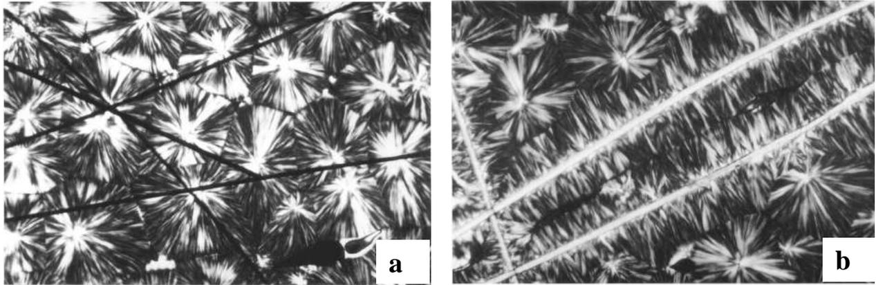
Figure 1-33 : Image optique dans du polypropylène a) avec des fibres de carbone, il n'y a pas formation de couche trans-cristalline b) Avec des fibres de Kevlar-29<sup>®</sup>, il y a formation d'une couche trans-cristalline.<sup>130</sup>
