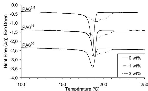
Figure 3-9 : Thermogrammes au refroidissement des composites avec 0 et 1 wt% de CNTs pour les PA6<sup>2.5</sup>, PA6<sup>15</sup> et le PA6<sup>30</sup>. ( $v = 10 \text{ }^\circ\text{C/min}$ )
