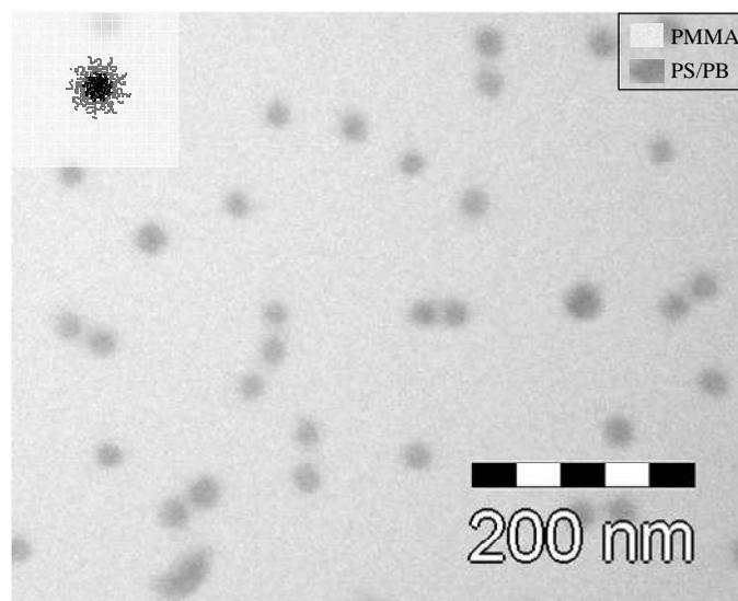
Figure 5-3 : Image TEM d'une solution de S<sub>14</sub><sup>11</sup>B<sub>19</sub>M<sub>67</sub> dans l'acétone déposée sur une grille de carbone à trous. (Marquage : Tétr oxyde d'osmium)
