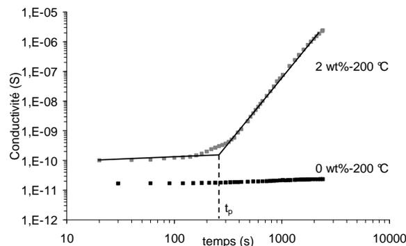
Figure 4-5 : Evolution isotherme de la conductivité à 200 °C pour les composés PMMA<sup>49</sup>-2NT et PMMA<sup>49</sup>-0NT en fonction du temps.
