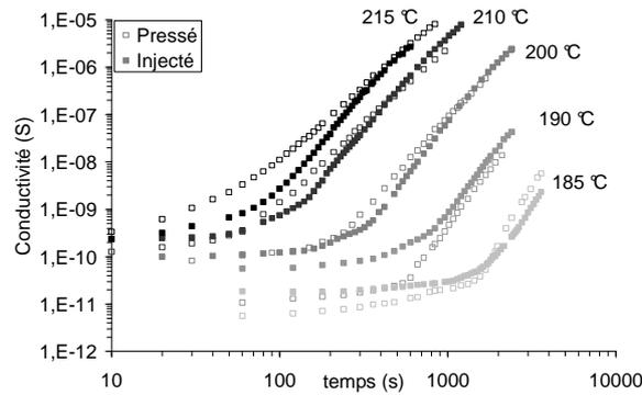
Figure 4-10 : Mesures de la conductivité, à différentes températures, dans le temps pour le composé PMMA<sup>49</sup>-2NT-200 pressé et injecté.
