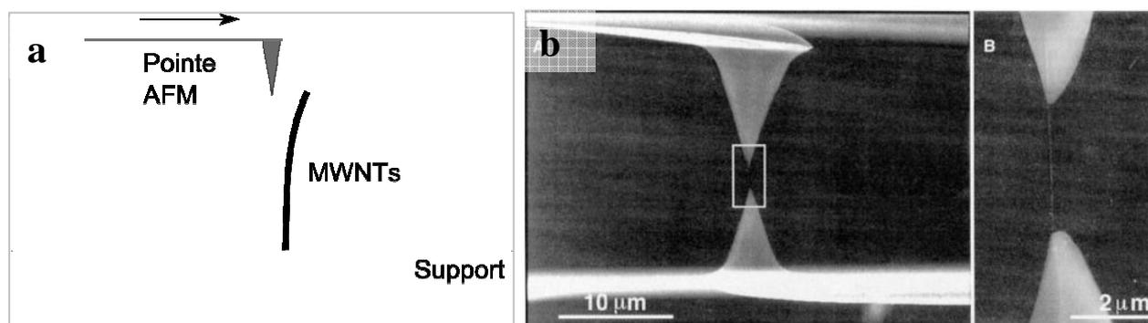
Figure 1-5 : a) Schéma de la mesure du module avec une pointe d'AFM b) Un MWNT tiré entre deux pointes AFM.<sup>13</sup>
