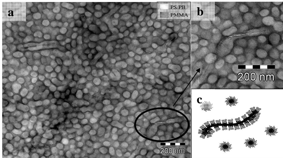
Figure 5-15 : a)-Image TEM d'un film de  $S_{14}^{11}B_{19}M_{67}$  avec 1 wt% de CNT évaporé à partir d'une solution dans l'acétone
