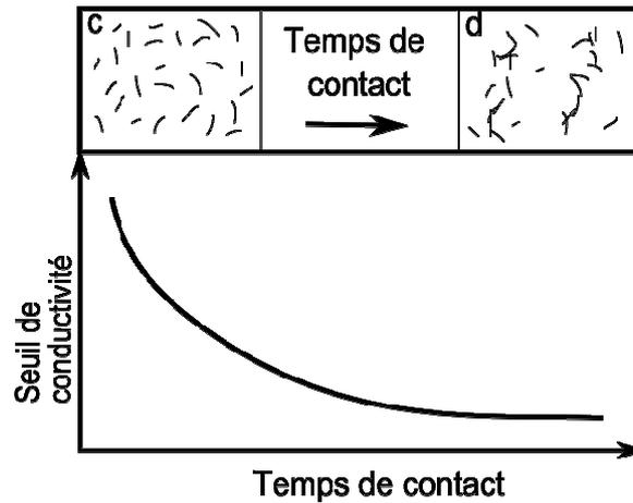
Figure 4-21 : Schéma de la diminution du seuil de conductivité pour un échantillon avec une dispersion homogène (c) qui avec un traitement permettant de reformer les contacts (d) augmente sa conductivité.
