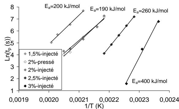
Figure 4-11 : Evolution du temps caractéristique « t<sub>p</sub> » en fonction de la température pour les composés PMMA<sup>49</sup>-NT à différentes concentrations.
