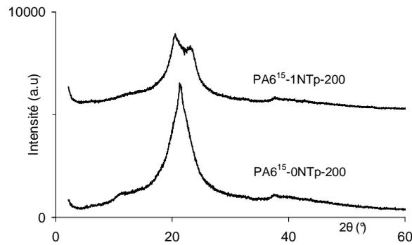
Figure 3-12 : Diffractogrammes WAXS des films trempés des composites PA6<sup>15</sup>-0NT-200 et PA6<sup>15</sup>-1NTp-200.
