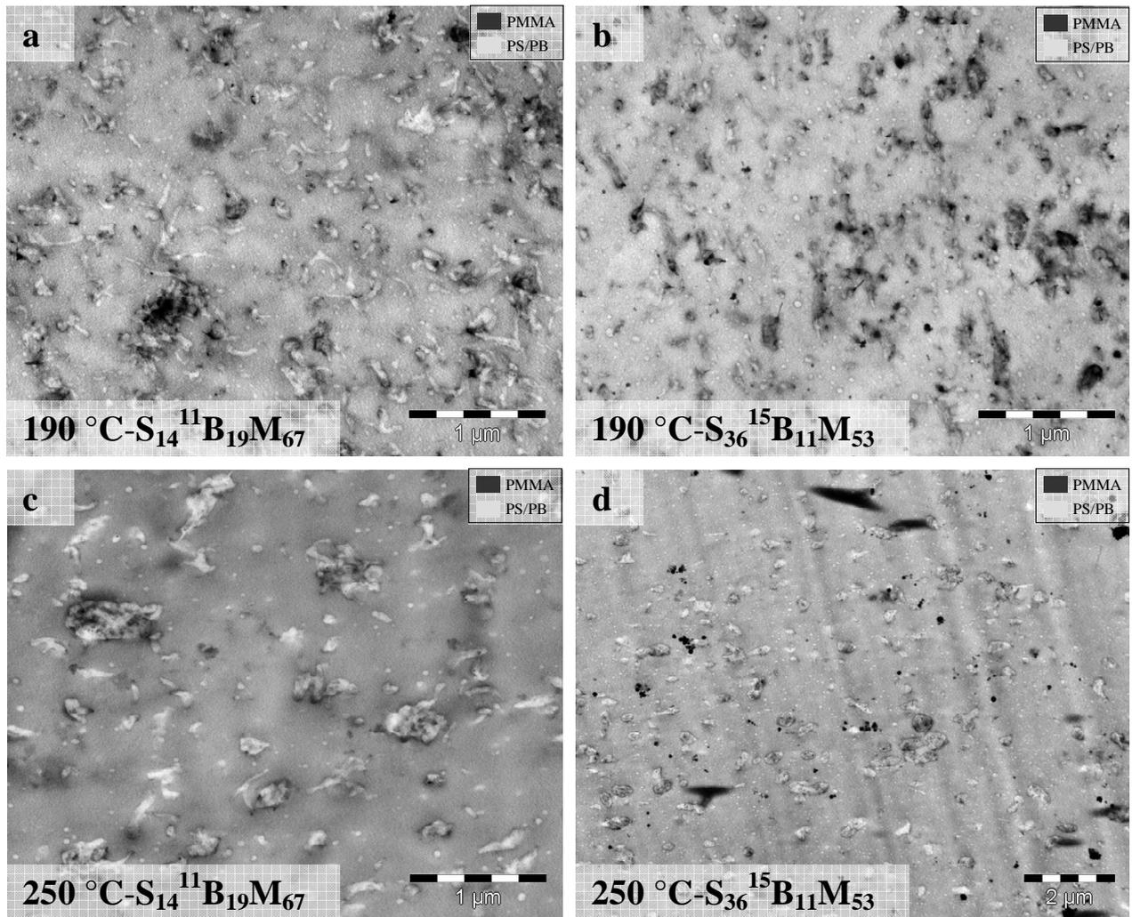
Figure 6-24 : Image TEM des composites a) PMMA-3NT-9S<sub>14</sub><sup>11</sup>B<sub>19</sub>M<sub>67</sub>-100 extrudé à 190 °C b) PMMA-3NT-9S<sub>36</sub><sup>15</sup>B<sub>11</sub>M<sub>53</sub>-100 extrudé à 190 °C c) PMMA-3NT-9S<sub>14</sub><sup>11</sup>B<sub>19</sub>M<sub>67</sub>-100 extrudé à 250 °C d) PMMA-3NT-9S<sub>36</sub><sup>15</sup>B<sub>11</sub>M<sub>53</sub>-100 extrudé à 250 °C. (Marquage : Acide phosphotungstique)
