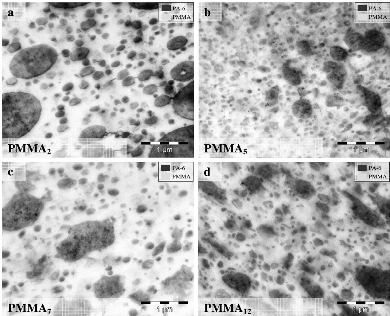
Figure A7-10 : Images TEM des composites a) PMMA<sub>2</sub>-1NT-30PA6<sup>15</sup> b) PMMA<sub>5</sub>-1NT-30PA6<sup>15</sup> c) PMMA<sub>7</sub>-1NT-30PA6<sup>15</sup> d) PMMA<sub>12</sub>-1NT-30PA6<sup>15</sup>. (Marquage : Acide phosphotungstique)
