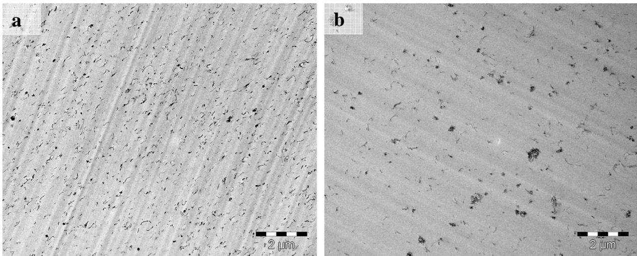
Figure 4-20 : Images TEM du composite PMMA<sup>49</sup>-1NTp-200 en coupe perpendiculaire extrudé à a) 190 °C b) 250 °C (Pas de marquage)
