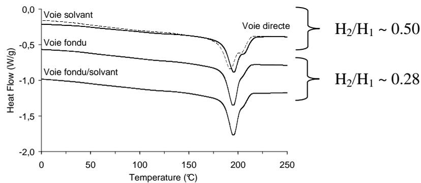
Figure 6-12 : Thermogramme au refroidissement des composites PA6<sup>15</sup>-1NT-9S<sub>14</sub><sup>11</sup>B<sub>19</sub>M<sub>67</sub>-100 (—) correspondant à différents modes de préparation indiqués sur la figure, PA6<sup>15</sup>-1NT-200 (---). ( $v = 10 \text{ °C/min}$ )
