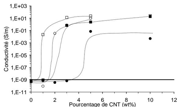
Figure A4-3 : Conductivité des composites  $S_{36}^{15}B_{11}M_{53}$ -NTp-200 (○) et  $S_{14}^{11}B_{19}M_{67}$ -NT-100 (□) après un traitement thermique à 190 °C (les symboles pleins) et 250 °C (les symboles vides).
