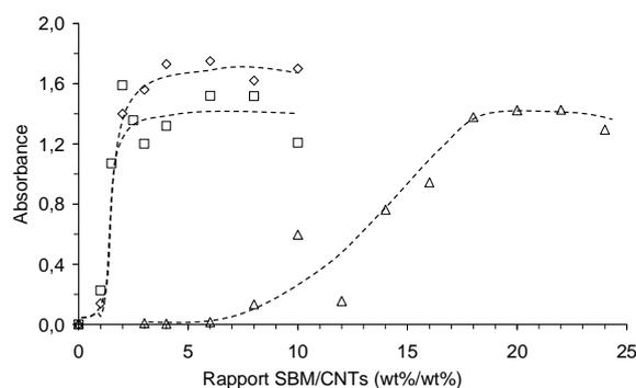
Figure 5-5 : Absorbance UV-visible pour différents SBM, le  $S_{14}^{11}B_{19}M_{67}$  ( $\diamond$ ), le  $S_{24}^{11}B_{31}M_{45}$  ( $\square$ ) et le  $S_{36}^{15}B_{11}M_{53}$  ( $\triangle$ ) en fonction du rapport massique SBM/CNTs.
