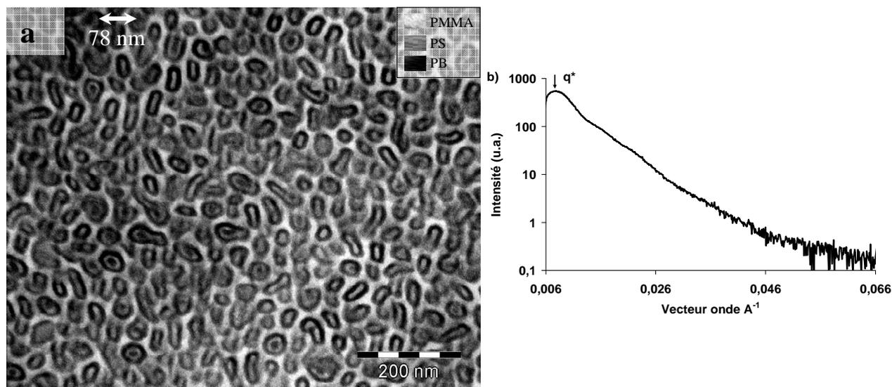
Figure 5-13 : a)-Image TEM d'un film de  $S_{14}^{11}B_{19}M_{67}$  évaporé à partir d'une solution dans l'acétone (Marquage : Tétroxyde d'osmium)
