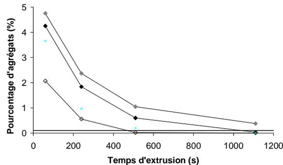
Figure 3-4 : Evolution du pourcentage d'agrégats en fonction du temps pour le composite PA6<sup>15</sup>-1NT extrudé dans différentes conditions à 250 °C, 100 rpm (◆) 250 °C, 200 rpm (◇) et 300 °C, 100 rpm(◇) et la limite de détection (—).
