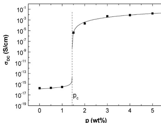
Figure 1-19 : Courbe de conductivité en fonction de la concentration en nanotubes de carbone dans le polycarbonate.<sup>84</sup>
