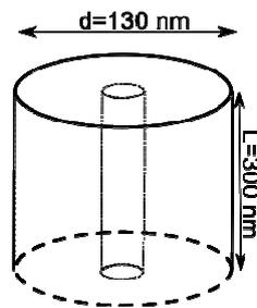
Figure 3-22 : Schéma d'un CNT avec sa couche trans-cristalline.
