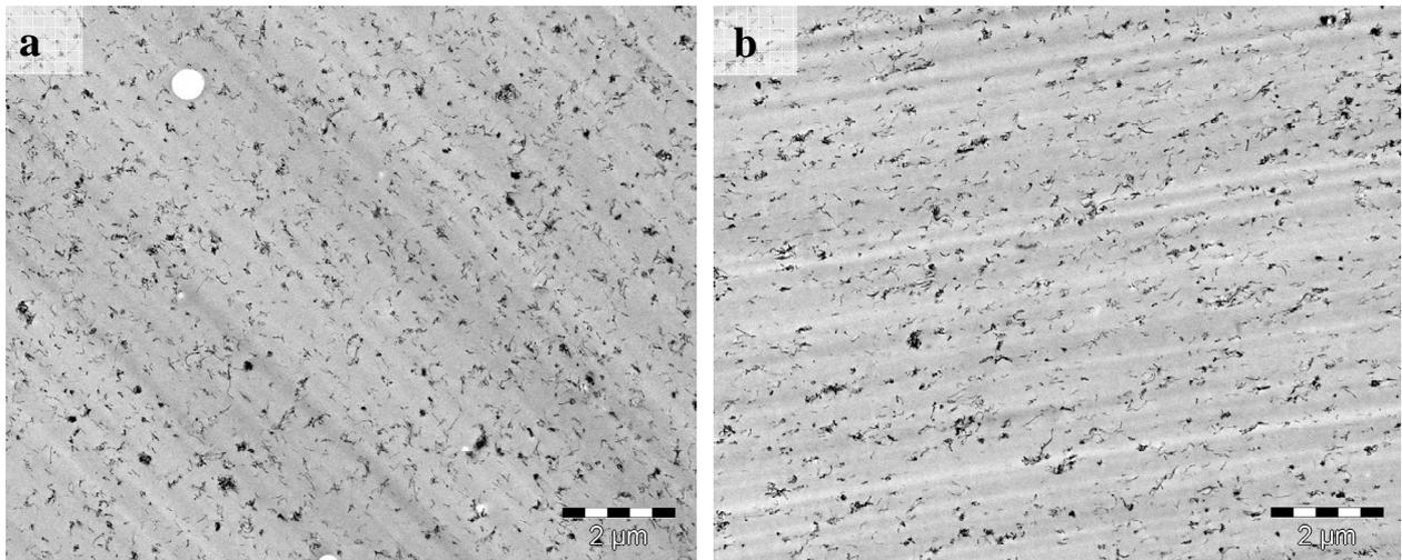
Figure 4-7 : Images TEM du composite PMMA<sup>49</sup>-2NT-200 en coupe perpendiculaire a) Non chauffé b) Chauffé à 200°C. (Pas de marquage)
