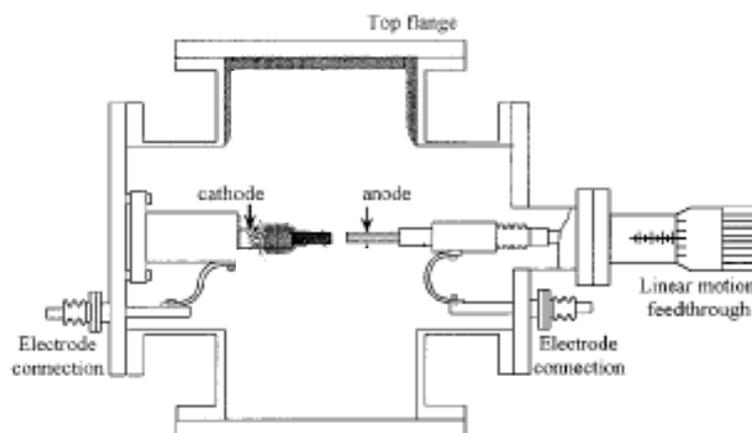
Figure 1-3 : Schéma de la synthèse des CNTs par décharge d'arc électrique.<sup>5</sup>
