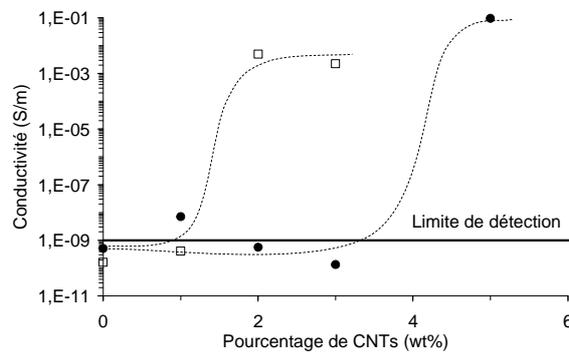
Figure 5-24 : Conductivité des composites  $S_{14}^{11}B_{19}M_{67}$ -NT-100 (●) et  $S_{14}^{11}B_{19}M_{67}$ -NTs (□) après précipitation/pressage.
