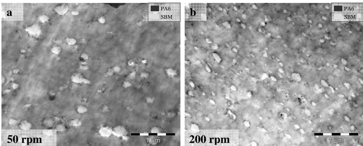
Figure 6-18 : Image TEM des composites a) PA6<sup>15</sup>-1NT-9S<sub>36</sub><sup>15</sup>B<sub>11</sub>M<sub>53</sub>-50 b) PA6<sup>15</sup>-3NT-9S<sub>36</sub><sup>15</sup>B<sub>11</sub>M<sub>53</sub>-200 en coupe // (Marquage: acide phosphotungstique).
