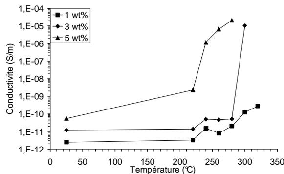
Figure 4-14 : Evolution de la conductivité dans les composites PA6<sup>15</sup>-NTp-200 à différents pourcentages en fonction de la température après un maintien de 40 min à cette température.
