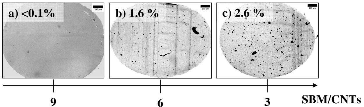
Figure 6-3 : Photos de microscopie optique a) PA6<sup>15</sup>-1NT-9S<sub>14</sub><sup>11</sup>B<sub>19</sub>M<sub>67</sub>S-100 b) PA6<sup>15</sup>-1NT-6S<sub>14</sub><sup>11</sup>B<sub>19</sub>M<sub>67</sub>S-100 c) PA6<sup>15</sup>-1NT-3S<sub>14</sub><sup>11</sup>B<sub>19</sub>M<sub>67</sub>S-100. Le nombre dans l'insert correspond au  $S_{CNTs}$  (%).
