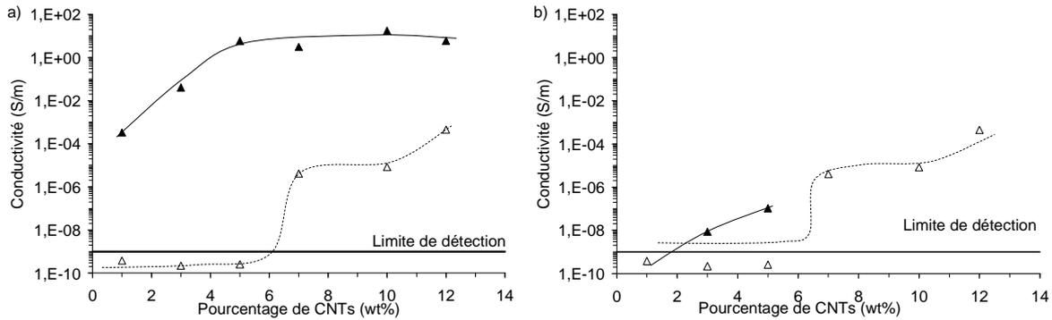
Figure 4-2 : Conductivité pour le composite PA-6/CNTs (PA6<sup>15</sup>-NTp-200)
