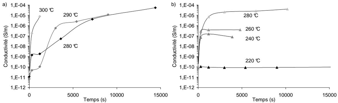
Figure 4-15 : Evolution de la conductivité dans les composites PA6<sup>15</sup>-NTp-200 a) 3 wt%, b) 5 wt% en fonction du temps à différentes températures.
