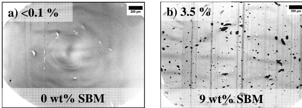
Figure 6-2 : Photos de microscopie optique des composites a) PA6<sup>15</sup>-3NTp-200 b) PA6<sup>15</sup>-3NT-9S<sub>14</sub><sup>11</sup>B<sub>19</sub>M<sub>67</sub>S-100. Le nombre dans l'insert correspond au  $S_{CNTs}$  (%).
