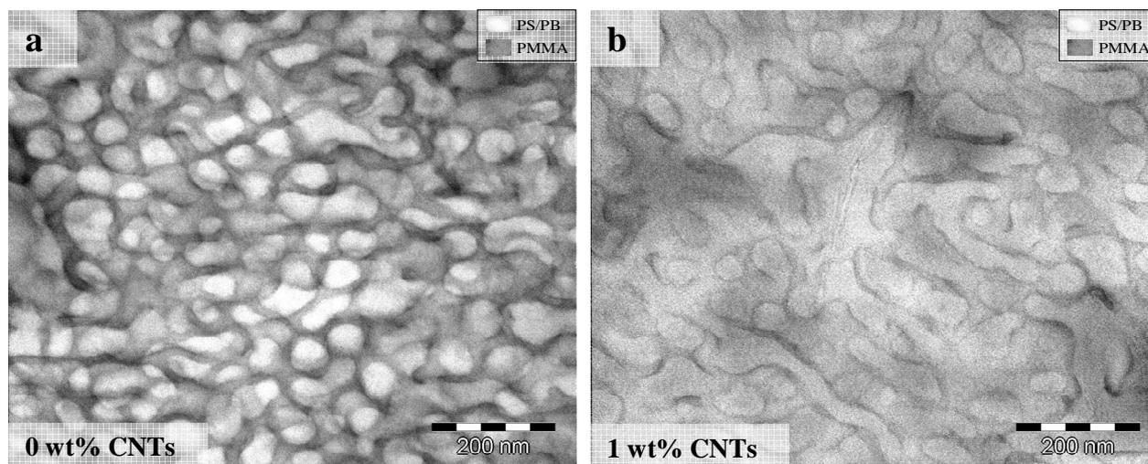
Figure 5-17 : Images TEM d'un film de  $S_{14}^{11}B_{19}M_{67}$  avec a) 0 et b) 1 wt% de CNTs évaporé à partir d'une solution dans l'acétone et recuit 24 h à 180 °C. (Marquage: acide phosphotungstique)
