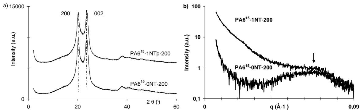
Figure 3-11 : Diffractogrammes des composites PA6<sup>15</sup>-0NT-200 et PA6<sup>15</sup>-1NTp-200 a) WAXS b) SAXS
