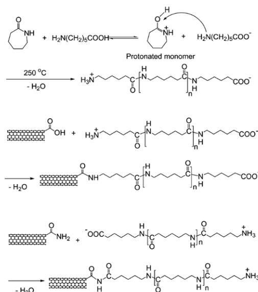
Figure 1-14 : Synthèse de composite SWNTs/PA-6 avec des nanotubes fonctionnalisés  $\text{COOH}$  et  $\text{CONH}_2$ .<sup>65</sup>
