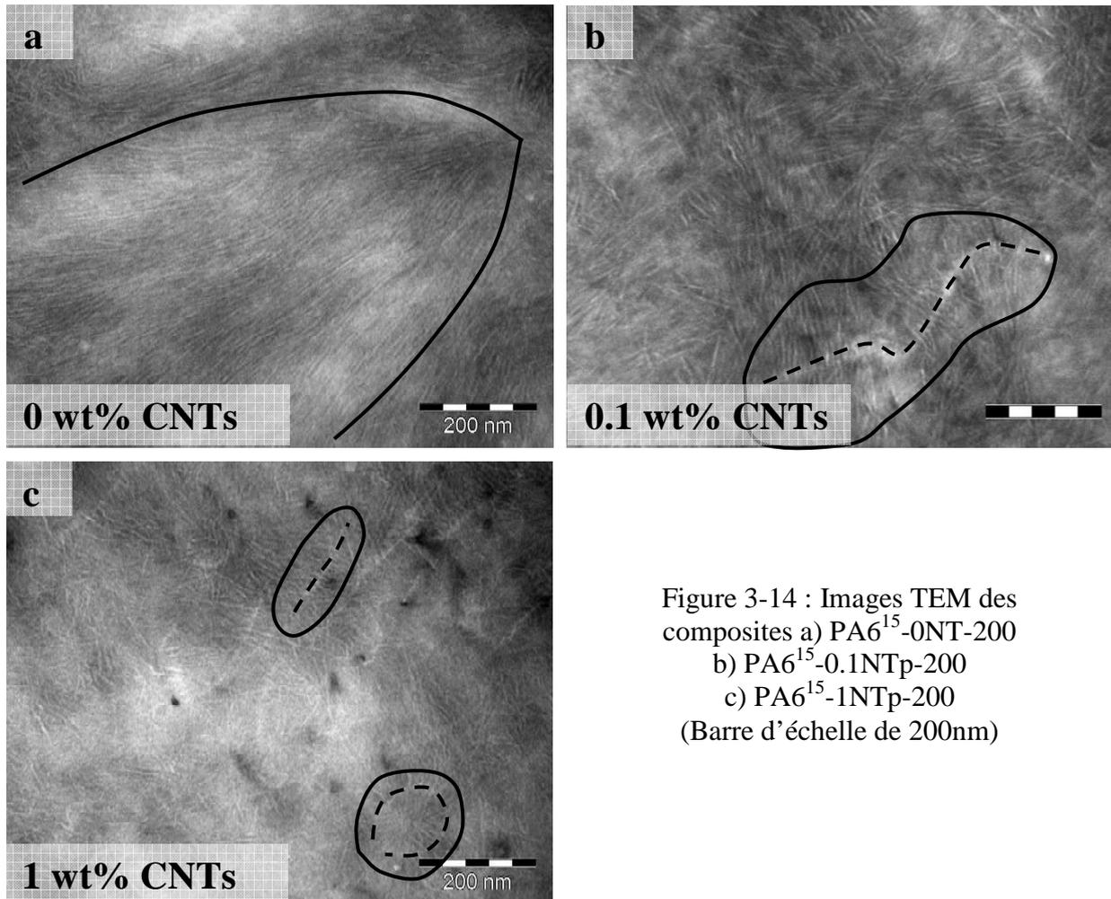
Figure 3-14 : Images TEM des composites a) PA6<sup>15</sup>-0NT-200
