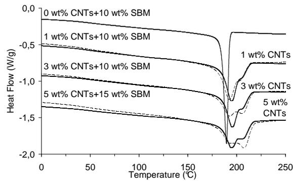
Figure A5-2: Thermogrammes au refroidissement pour différents composites PA6<sup>15</sup>-NT-S<sub>36</sub><sup>15</sup>B<sub>11</sub>M<sub>53</sub>-100 (—) et PA6<sup>15</sup>-NT-200 (---). Les pourcentages massiques de CNTs et de SBM sont marqués sur la figure. (v = 10 °C/min)
