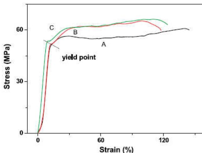
Figure 1-16 : Courbe de traction du PA6 (Courbe A) et de PA6/CNTs (Courbe B et C).<sup>77</sup>
