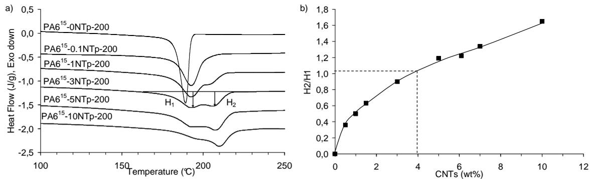
Figure 3-7 : a) Thermogrammes des composites PA6<sup>15</sup>-NTp-200 avec différents taux de charges au refroidissement b) Rapport  $H_2/H_1$  en fonction du pourcentage de CNTs.
