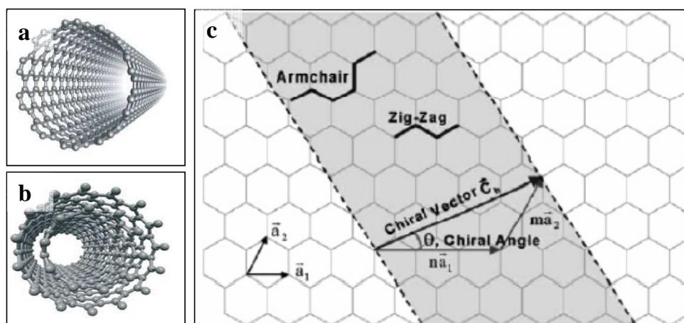
Figure 1-2 : a) Schéma d'un SWNT b) Schéma d'un MWNT c) Orientation possible du feuillet de graphène lors de son enroulement pour former un nanotube de carbone.<sup>3</sup>
