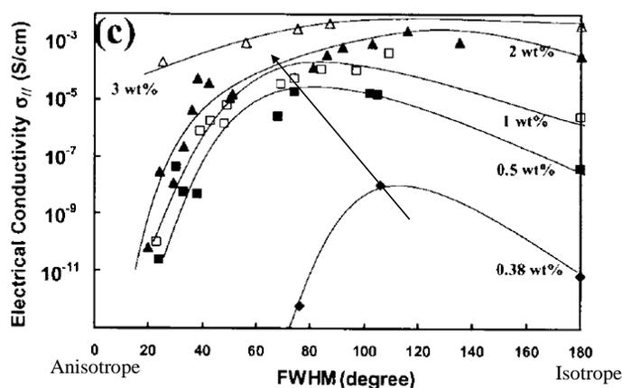
Figure 1-25 : Conductivité en fonction de degré d'orientation des nanotubes pour différents taux de charges.<sup>102</sup>
