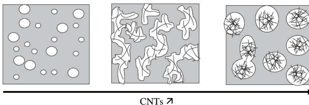
Figure 1-29 : Changement de morphologie de domaines sphériques à des domaines co-continus puis à des domaines sphériques de tailles plus importantes avec l'augmentation de la concentration en CNTs.<sup>118</sup>
