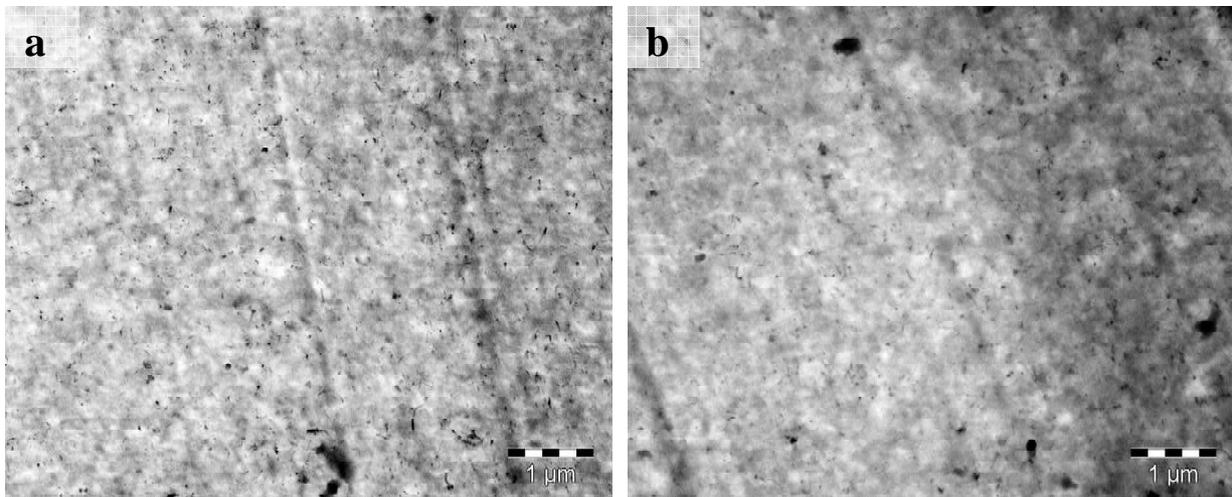
Figure 3-6 : Images TEM des composites a) PA6<sup>15</sup>-1NT-100 b) PA6<sup>15</sup>-1NTp-200 en coupe parallèle (sans marquage).
