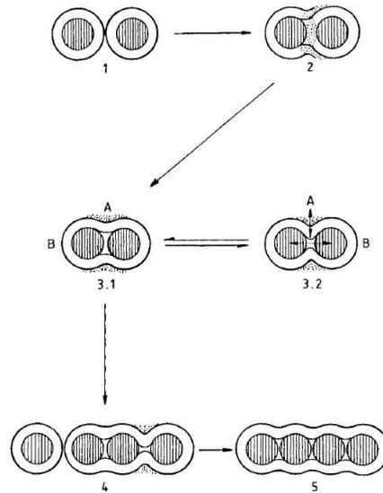
Figure 1-21 : Modèle de transition de phase proposé par Wessling. Les particules sont distribuées de façon isotrope dans le matériau et au passage de la transition de phase, elles coagulent.<sup>93</sup>
