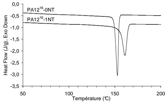
Figure 3-18 : Thermogrammes au refroidissement des composites PA12<sup>16</sup>-NT avec 0 ou 1 wt% de CNTs. ( $v = 10 \text{ }^\circ\text{C}/\text{min}$ )
