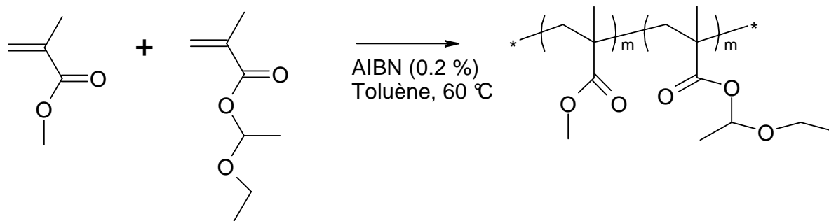
Figure A6-2 : Synthèse du P(MMA-co-MAA) avec 12 % d'acide méthacrylate.
