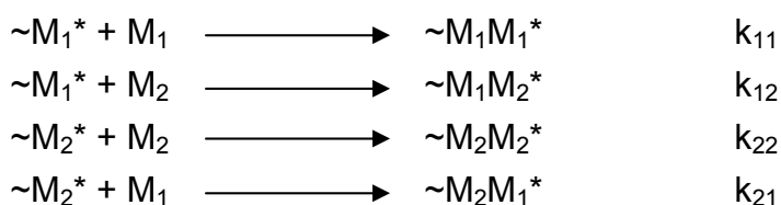
Figure 5 : Différentes réactions de propagations possibles lors de la copolymérisation des monomères 1 et 2.
