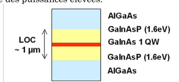
Figure III-1 : Structure verticale des diodes laser.
