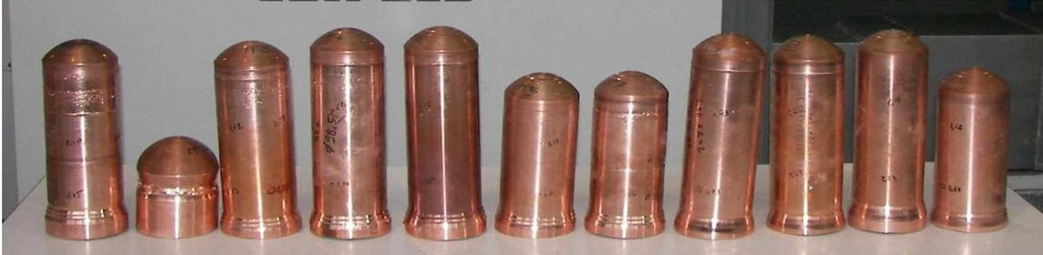
Figure 56: Pièces en cuivre fluotournées
