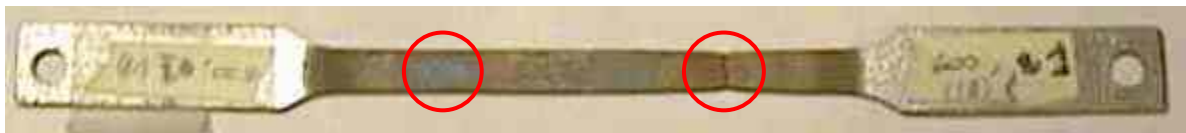
Figure 4.26 : concentration de la déformation due au gradient
