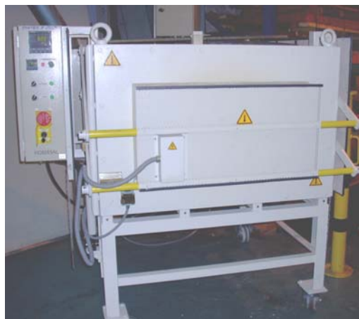
Figure 5.17 : four utilisé pour l'auténitisation des flans
