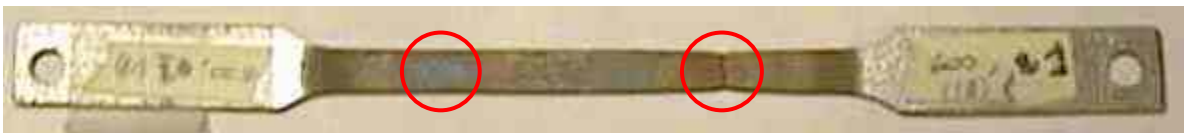
Figure 4.26 : concentration de la déformation due au gradient
