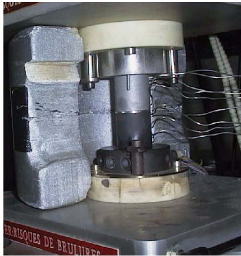
Figure 3.16 : configuration du dispositif expérimental de mesure de température
