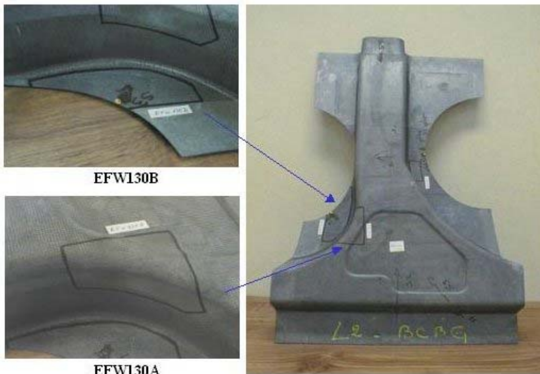
Figure 5.57 : zones de mesure des déformations (secteurs A et B)
