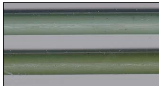
Figure 20 : Coupe transversale et échantillon de joncs en PET pur
