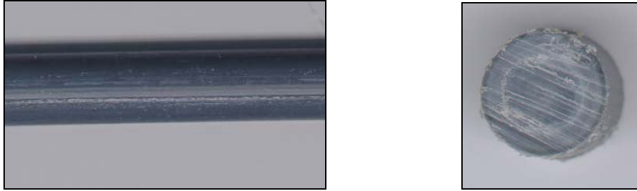
Figure 28 : Jonc de mélange 80/20 pour une vitesse de rotation de 78 tr/min
