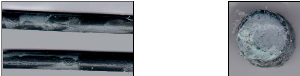
Figure 12 : Joncs hétérogènes Mélange 90/10 – Coupe transversale
