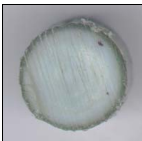
Figure 20 : Coupe transversale et échantillon de joncs en PET pur
