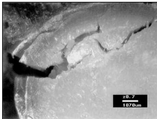
Figure 32 : Structure du type 4 : Schéma de l'échantillon après essai Photographie du plot. Destruction d'une partie du plot Effondrement dans le sens transversal
