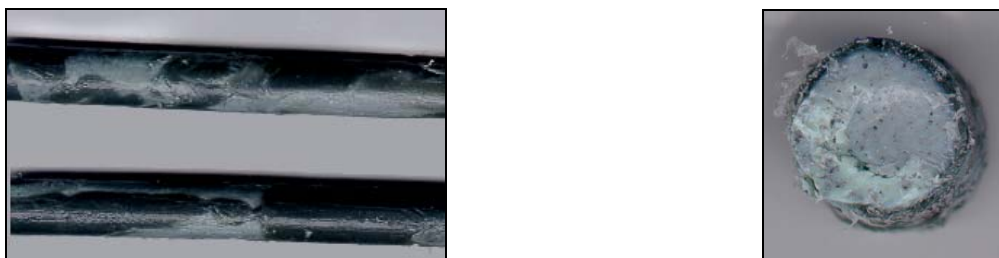
Figure 12 : Joncs hétérogènes Mélange 90/10 – Coupe transversale
