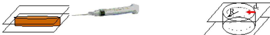
Figure V.10 Représentation schématique de l'expérience servant à mesurer le coefficient de diffusion du non-solvant vers l'échantillon.
